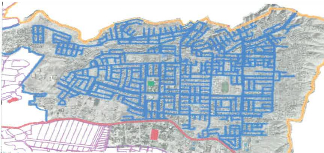
Gráfico 5 Red de Alcantarillado
