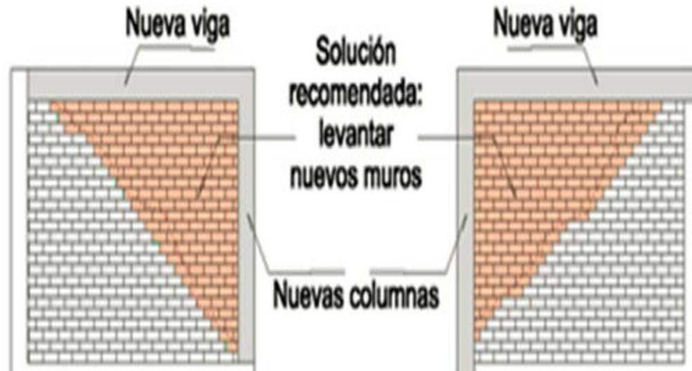
b) Las nuevas columnas deben quedar bien empotradas en la cimentación y, en la parte superior, las varillas de acero bien conectadas con las varillas de la viga. Los muros y vigas deben conectarse adecuadamente con las varillas de la columna existente.
