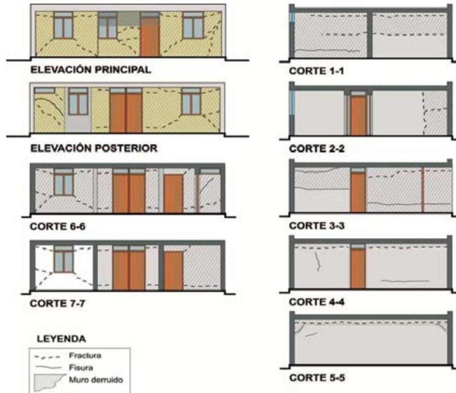
F-4.14. Elevación de las dos fachadas y sus cortes donde se muestran fisuras y grietas. Las fisuras y grietas de los muros en la dirección perpendicular a la fachada cortes 1-1 a 1-5, pueden haberse producido por que el techo tuvo un pequeño desplazamiento horizontal durante el intenso sismo.
