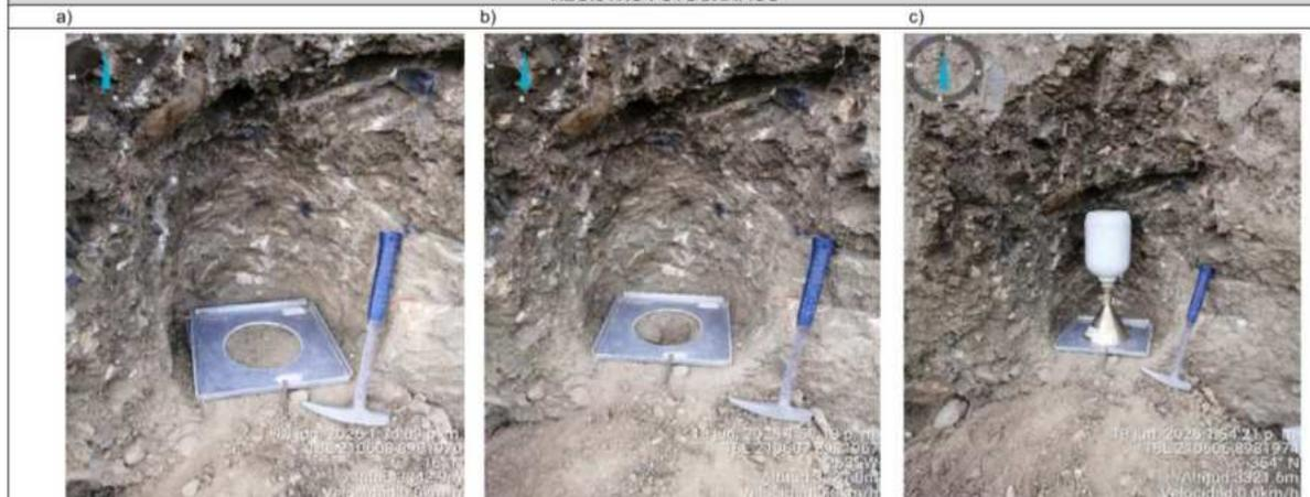
Fotografía: a) Preparación del suelo para la realización del ensayo in situ, b) Excavación del hoyo, c) Realización del ensayo de densidad en el depósito inconsolidado.
