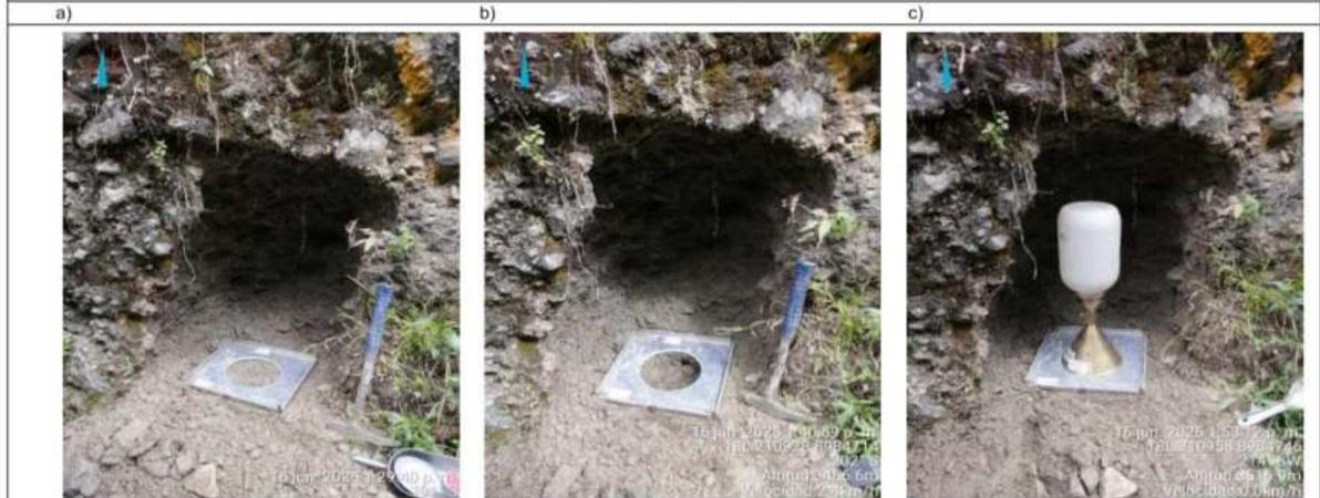
Fotografía: a) Preparación del suelo para la realización del ensayo in situ, b) Excavación del hoyo, c) Realización del ensayo de densidad en el deposito glaciario.
