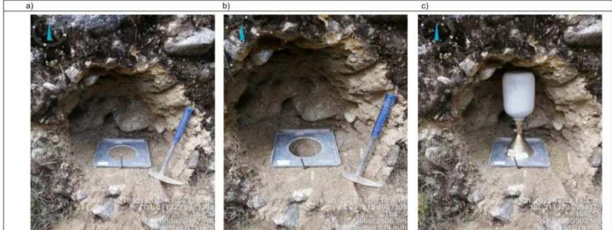
Fotografía: a) Preparación del suelo para la realización del ensayo in situ, b) Excavación del hoyo, c) Realización del ensayo de densidad en el depósito inconsolidado.
