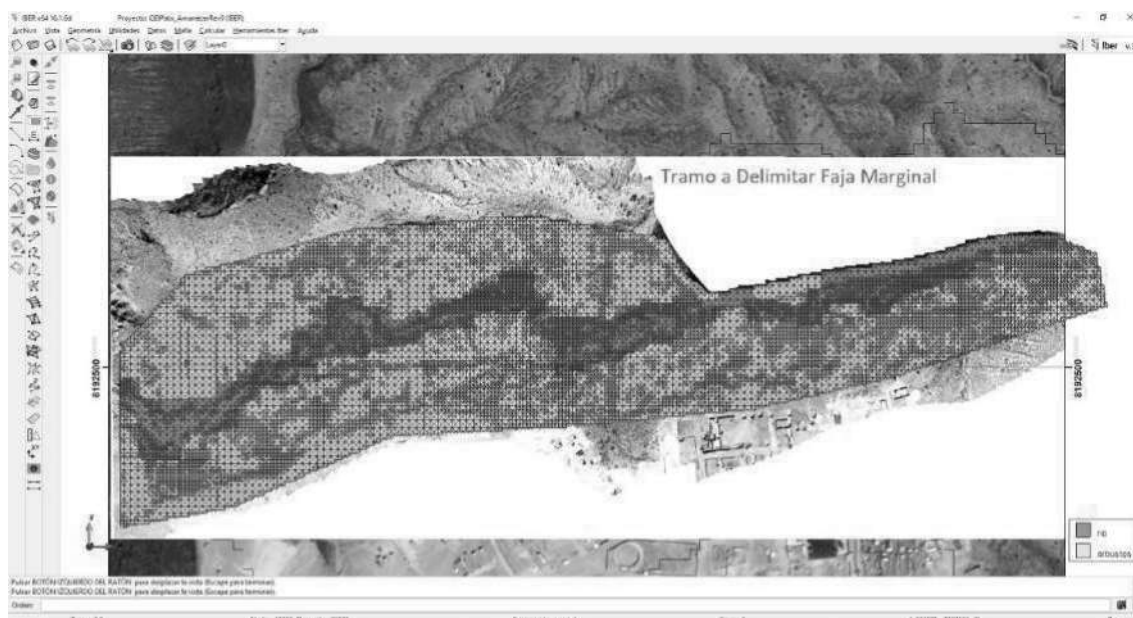
Ilustración 32 – Coeficientes de Rugosidad de Manning asignados en el mallado del software Iber
