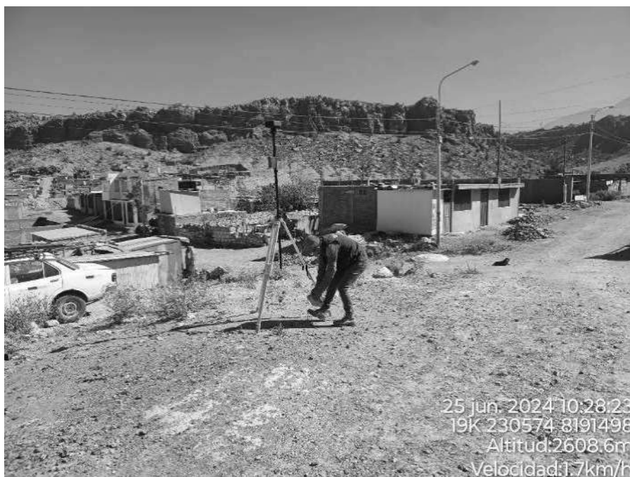
Ilustración 21 –Vista Panorámica del trabajo de campo: emplazamiento de la estación RTK
