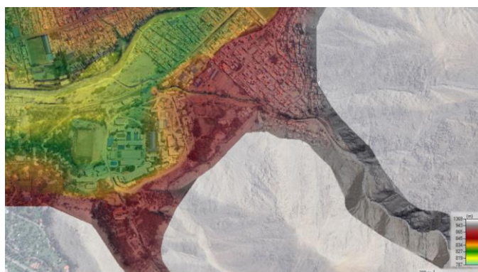
Figura 3: Modelo Digital de Elevación de la quebrada Santo Domingo
