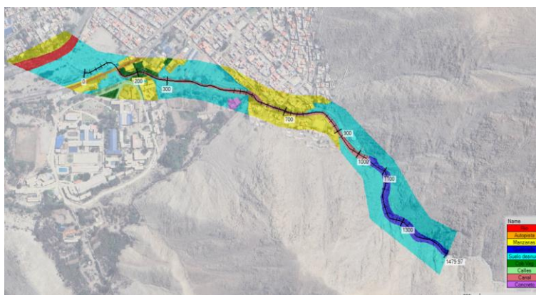
Figura 9: Rugosidad en el modelo hidráulico
