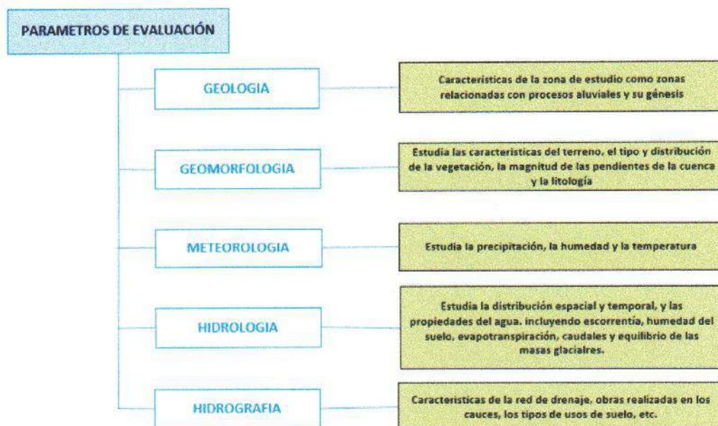
Ilustración 31. Parámetros de evaluación ante inundación.
