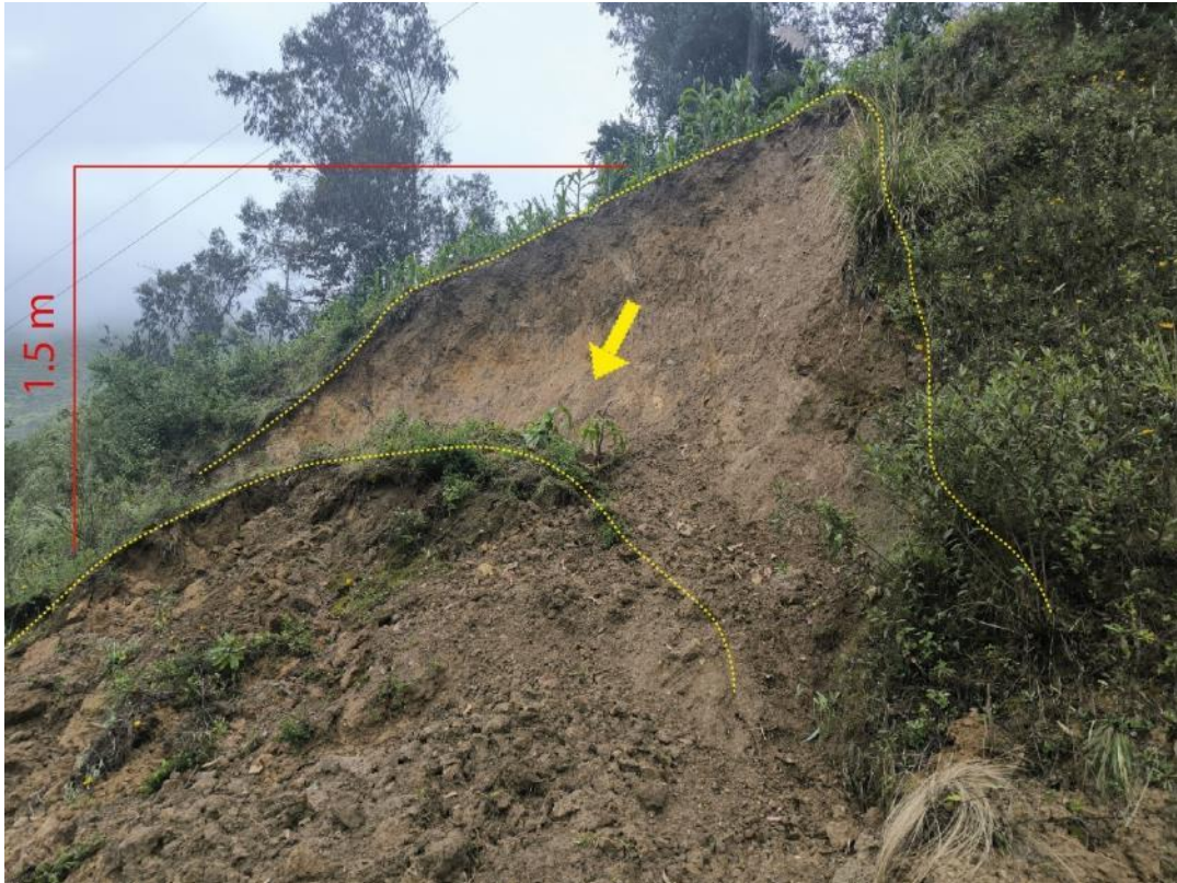
Figura 10: Desplazamientos de 1.5 m desde la zona de arranque en el derrumbe inactivo latente (D-il1), muestra evidencias de desprendimientos recientes bajos.
