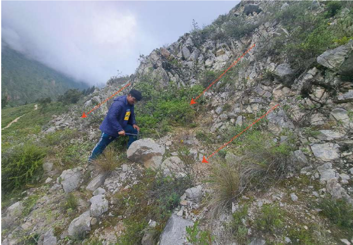
Figura 13. Vista del afloramiento rocoso fuertemente fracturado y ligeramente meteorizado, con dirección de desprendimiento de noroeste hacia el sureste.
