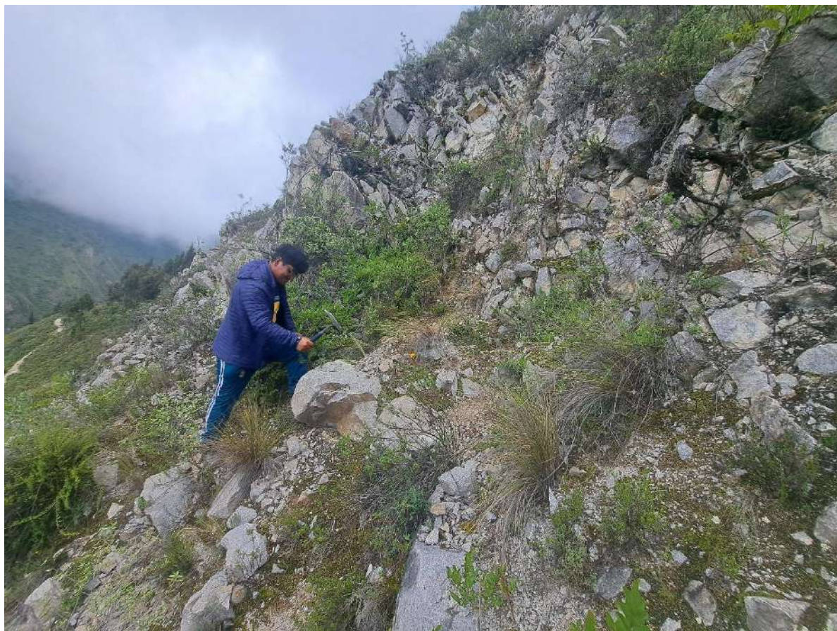
Fotografía 1. Vista del afloramiento de monzogranito, el cual se encuentra medianamente a muy fracturado.
