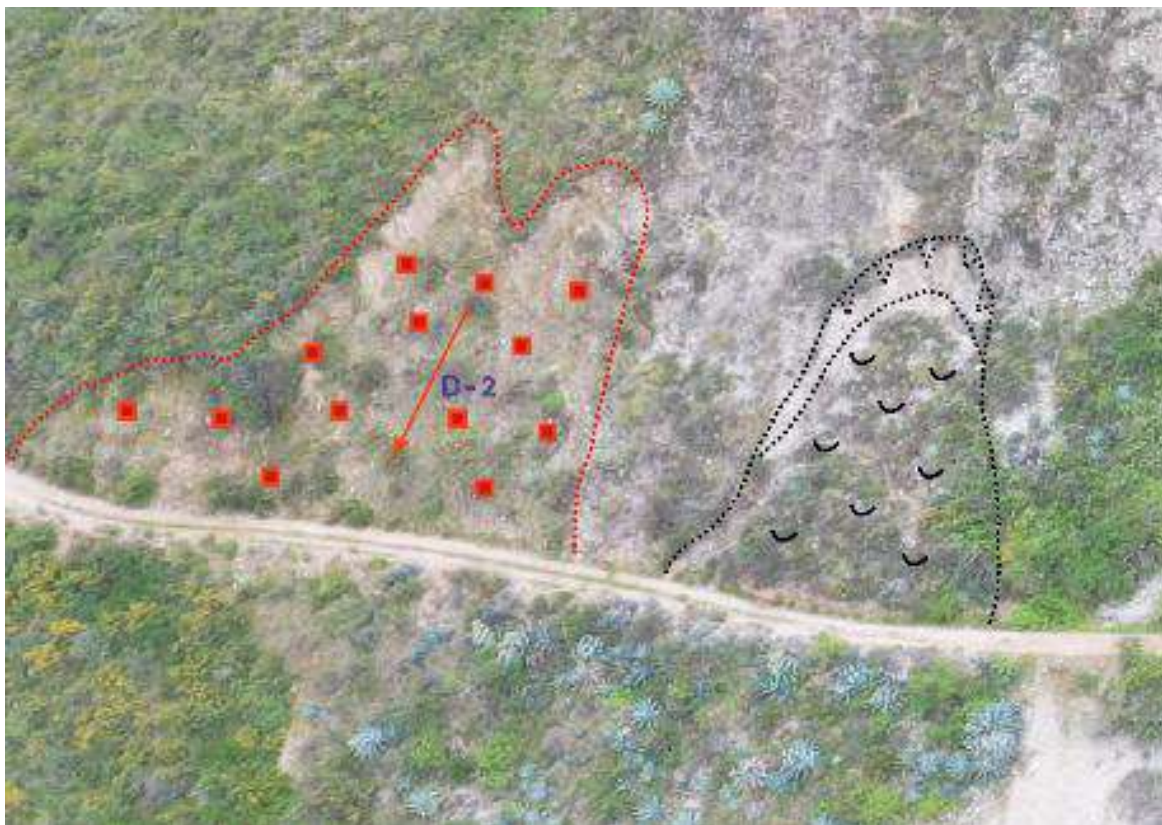
Figura 11. Derrumbe 2 (D-2) con una longitud de arranque de 18.5 m y altura de arranque 10.5 m, donde se puede distinguir material coluvial que fue depositado al pie del talud, susceptibles a ser removidos con facilidad durante lluvias excepcionales.
