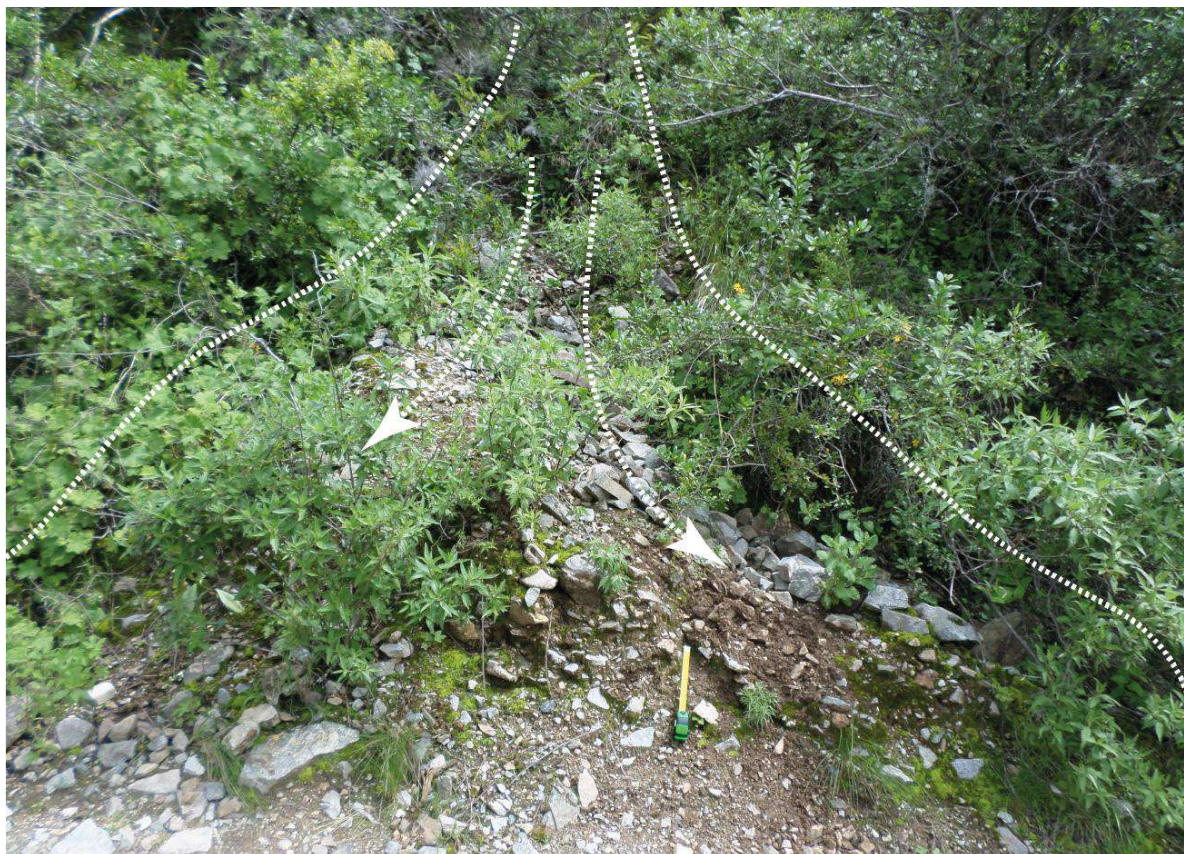
Figura 16. Depósito de flujo de detritos, donde se muestra un espesor de 60 cm cuyo depósito está conformado por fragmentos rocosos heterométricos cantos (20%), gravas (50%), limo, arena, arcilla (30%), ubicado con coordenadas 8858820 N; 260469 E.
