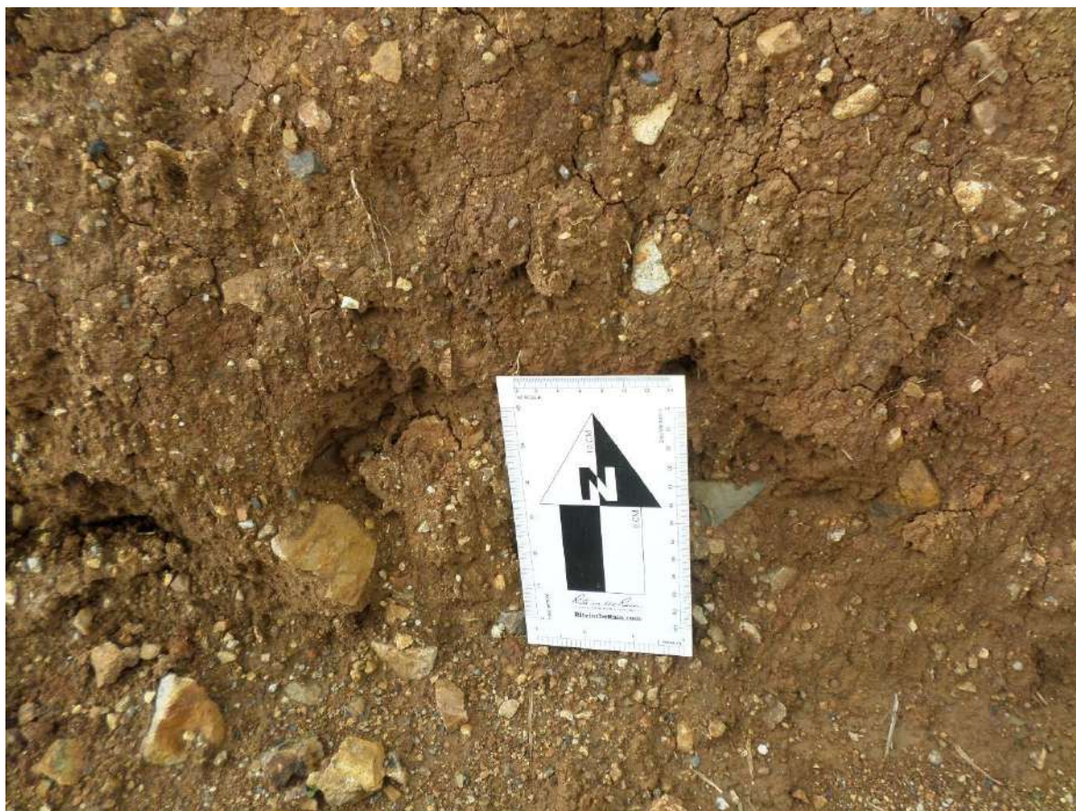
Fotografía 3. Vista del depósito coluvio-deluvial, correspondiente al depósito de un deslizamiento antiguo, ubicado en el Anexo Huanchay.
