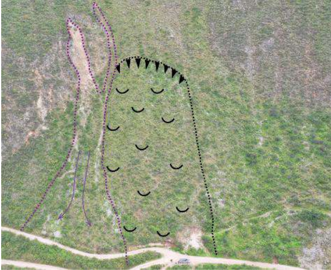
Figura 15. Vista del deslizamiento delimitado en líneas de color negro, presenta un escarpe reciente de 1 m con una longitud de escarpe de 50 m, en el flanco derecho del deslizamiento se observa un flujo de detritos antiguo (enmarcado en líneas morado) sobre el cual ocurren pequeñas reactivaciones de flujos de detritos.
