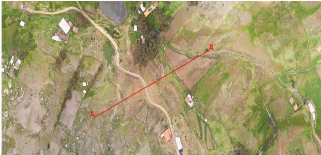
Figura 16. Corte A-A', sobre el modelo digital de terreno (MDT), el cual corta el deslizamiento rotacional en el sector Jatun Zanja, sector Santa Cruz, se muestra la zona de inicio, el recorrido de la masa y donde se asentó (trocha carrozable).
