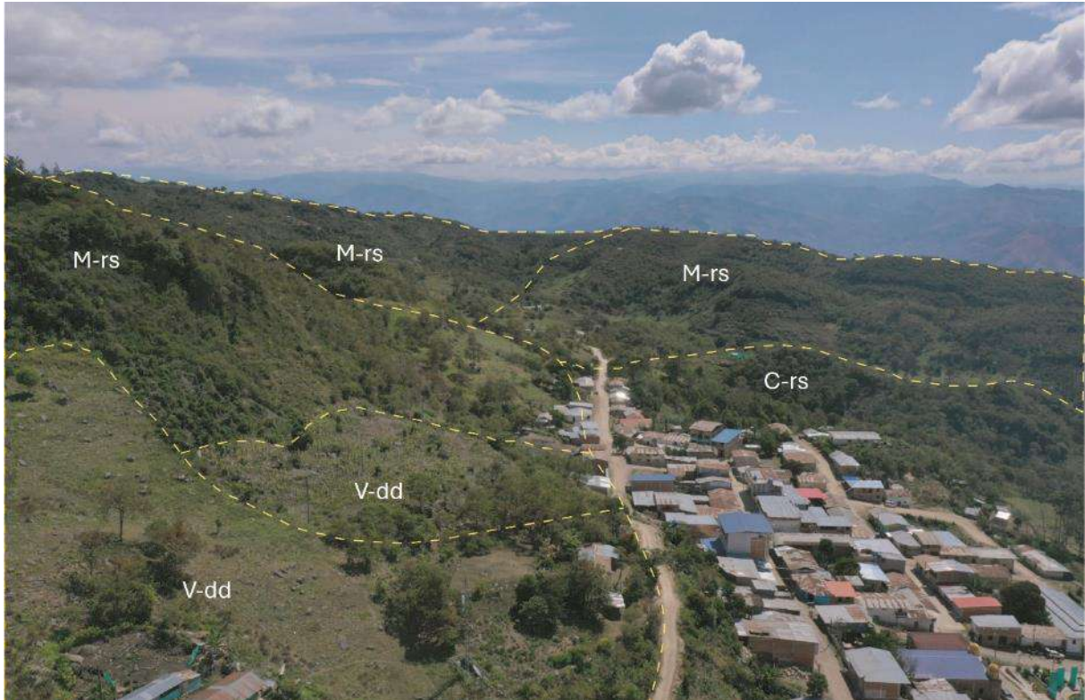
Figura 13. Vista panorámica de las subunidades geomorfológicas que se observan en el C.P. Nueva Esperanza y alrededores: Montaña en roca sedimentaria (M-rs), colinas en roca sedimentaria (C-rs), vertiente con depósito de deslizamiento (V-dd).
