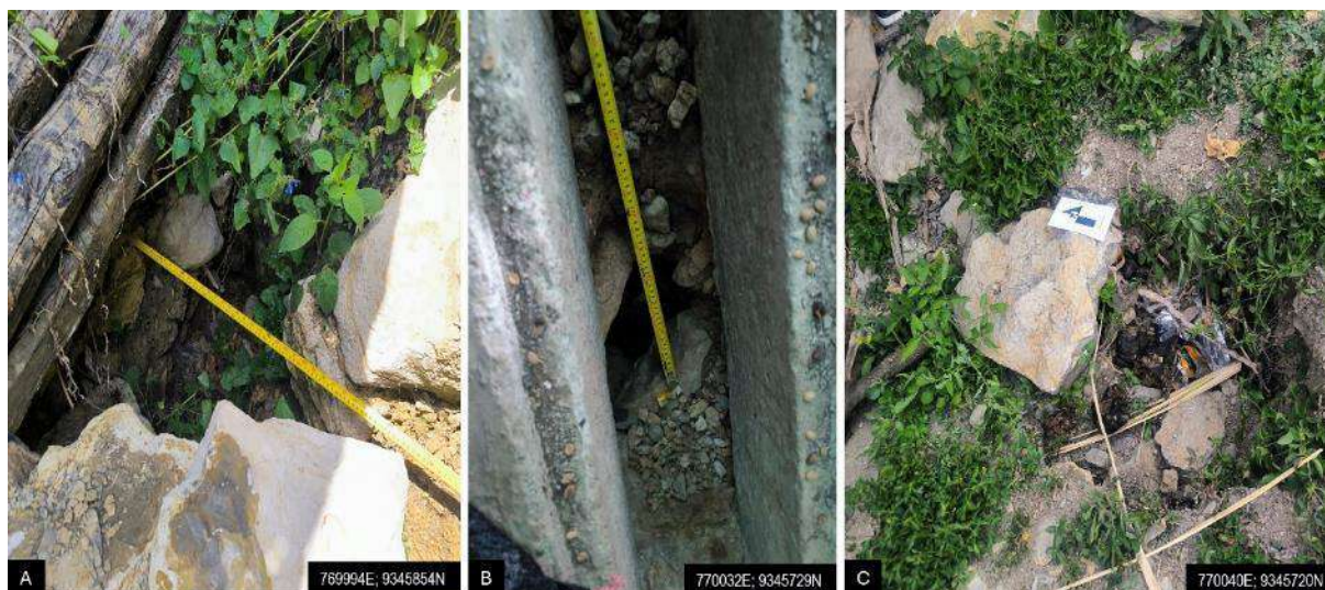
Figura 18. Hundimientos localizados en C.P Nueva Esperanza
