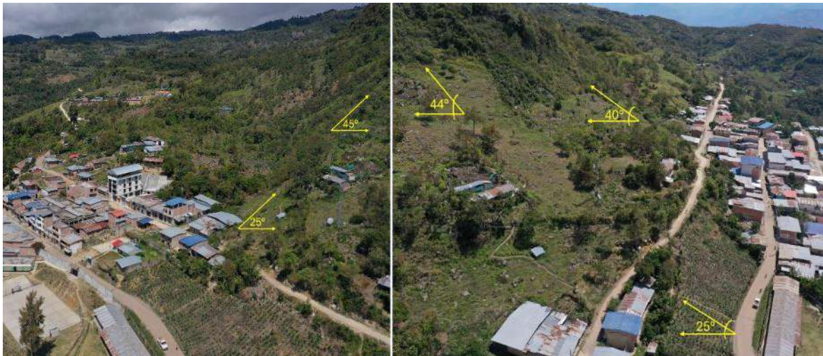
Figura 14. Vista panorámica de la subunidad geomorfológica Montaña en roca sedimentaria (M-rs), donde se pueden observar las inclinaciones (amarillo) alrededor del centro poblado Nueva Esperanza.
