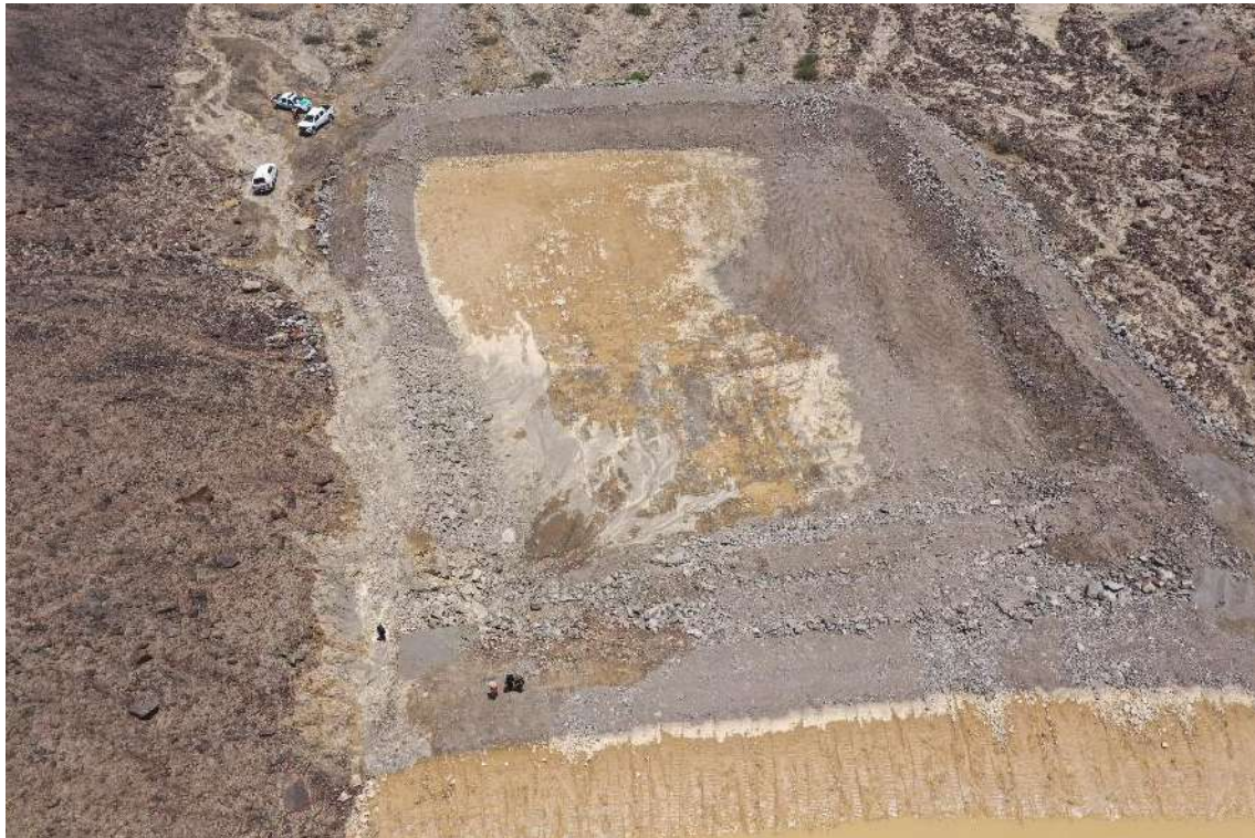
Fotografía 21. Pozo de sedimentación para retener el material generado por los flujos (huaicos). Coordenadas UTM 428231 E; 8456483 N.
