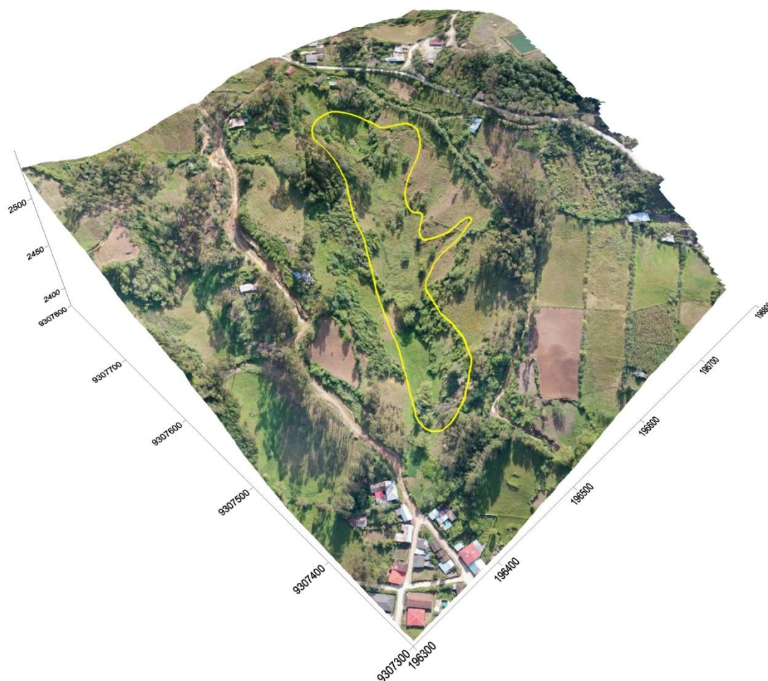
Figura 6. Modelo 3D de la localidad de Soloco, el deslizamiento está delimitado en línea amarilla, se aprecia pastos naturales y terrenos con cultivos agrícolas afectados; así mismo se aprecian las viviendas expuestas en la parte baja.
