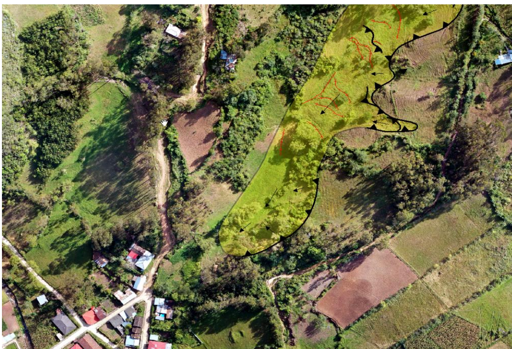
Figura 7. Se observa sobre el deslizamiento (línea negra), y agrietamientos (en línea roja), lo que permite la infiltración directa del agua de escorrentía, acelerando la saturación de los terrenos; también se observan las viviendas expuestas al peligro ubicadas al sur oeste del sector evaluado.
