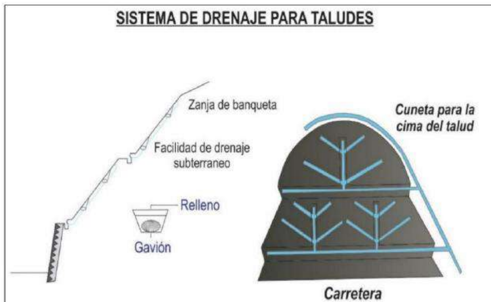
Figura 39. Drenaje tipo espina de pescado. Tomado de INGEMMET (2000).
