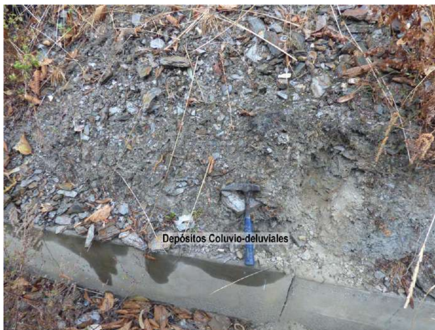
Figura 11. Detalle de los fragmentos heterométricos que conforman los depósitos coluvio-deluviales.
