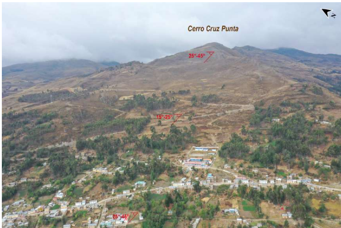
Figura 14. Pendiente promedio de 25°-45° en la parte media a alta de la ladera suroeste del cerro Curi Punta. Nótese, la expansión urbana de manera escalonada con tendencia ascendente. Vista panorámica mirando al noreste.
