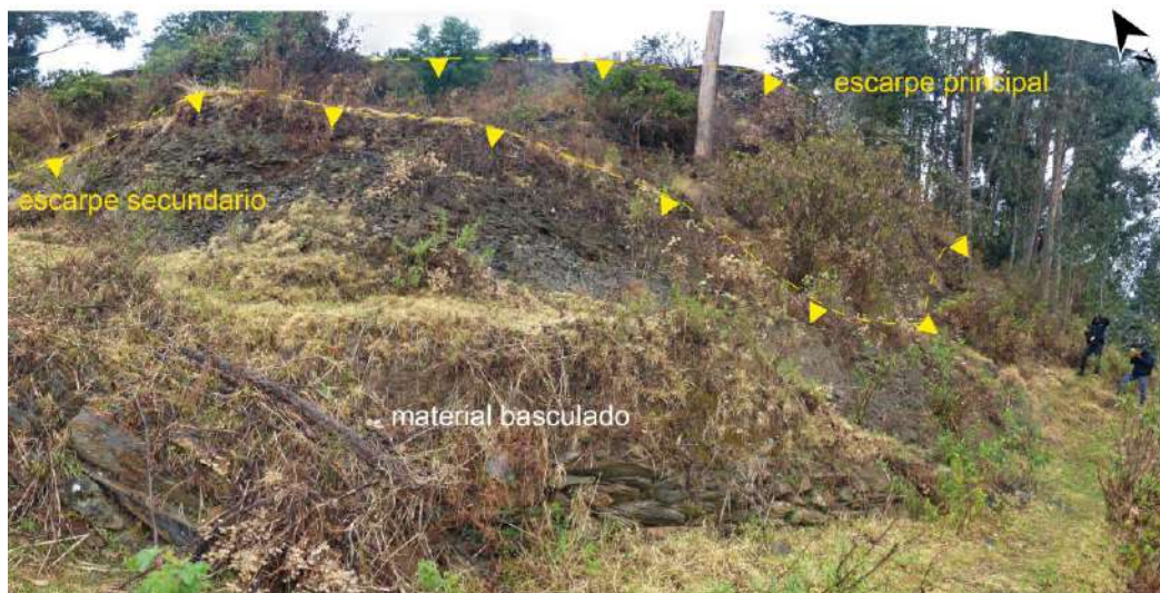
Figura 28. Escarpes múltiples que dejan desnivel de terreno de 12 a 4 m en la vertical (E: 313099; N: 8937045).
