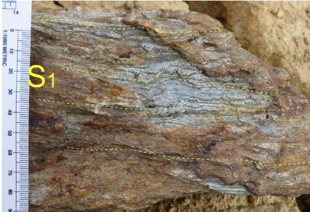
Figura 8. Detalle de los esquistos micáceos con foliación ( S_1 ) bien definida y fuertemente meteorizadas, atribuidas al Complejo Metamórfico del Marañón.
