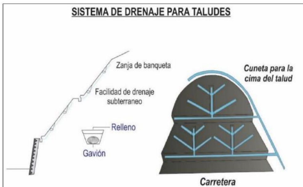
Figura 27. Drenaje tipo espina de pescado. Tomado de INGEMMET (2000).
