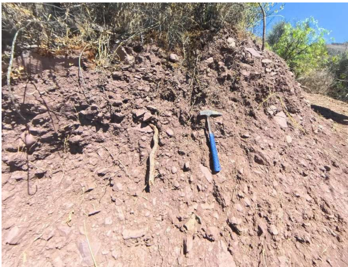
Fotografía 3. Vista de depósito coluvio-deluvial, formando por fragmentos líticos, angulosos a subangulosos, heterométricos de hasta 0.15 m de diámetro, envueltos en matriz arcilloso limo-arenoso. Coordenadas referenciales UTM WGS-84, 18S: E: 575922; N: 8543829
