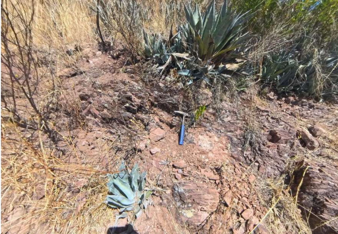
Fotografía 1. Coladas andesíticas de la Formación Sallalli. Geotécnicamente, el macizo rocoso se presenta fuertemente fracturado y muy meteorizado en superficie. Coordenadas referenciales UTM WGS-84, 18S: E: 575856; N: 8543751.
