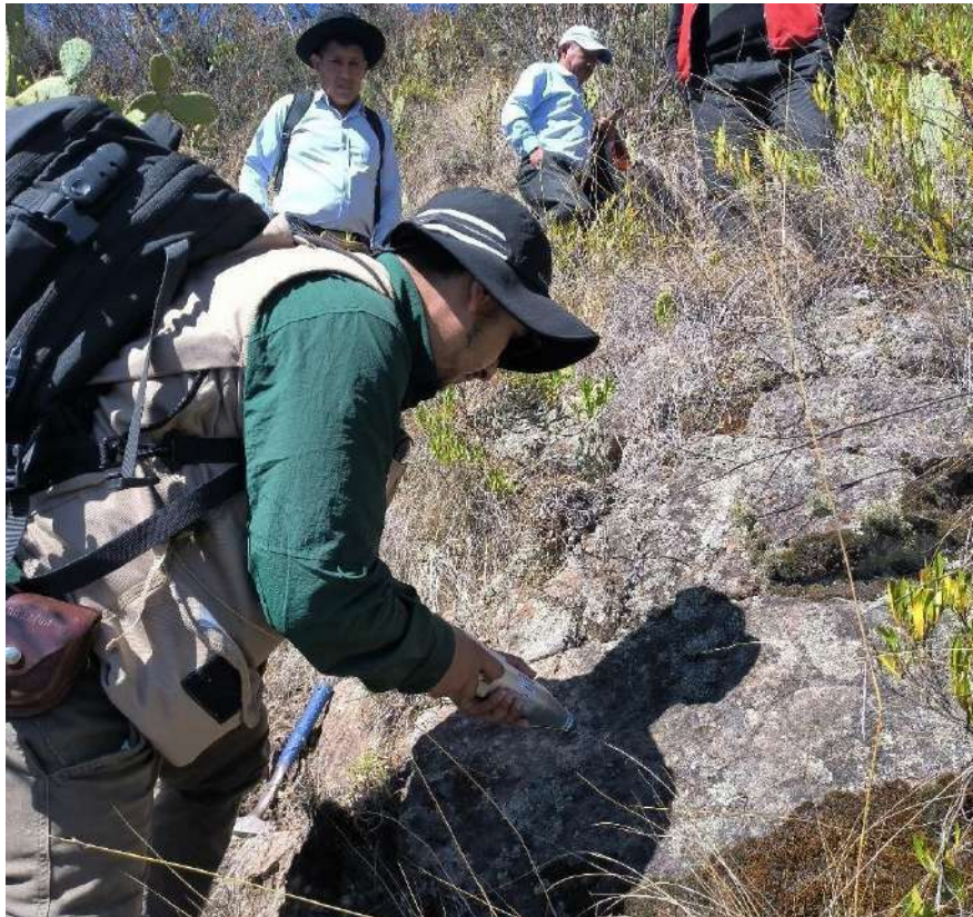
Fotografía 2. Ensayo con el martillo de Schmidt para la estimación de la resistencia de la matriz rocosa bajo la metodología de la ISRM (1981) en tobos de la Formación Sallalli. Coordenadas referenciales UTM WGS-84, 18S: E: 576046; N: 8543473.
