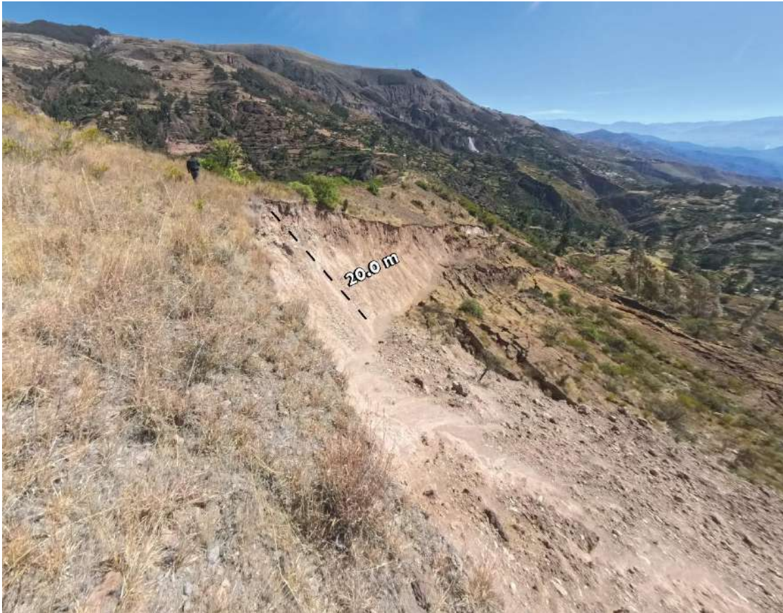
Figura 7. Vista del escarpe principal de forma irregular y continua de 480 m de longitud y salto vertical que varían de 15 a 20 m.
