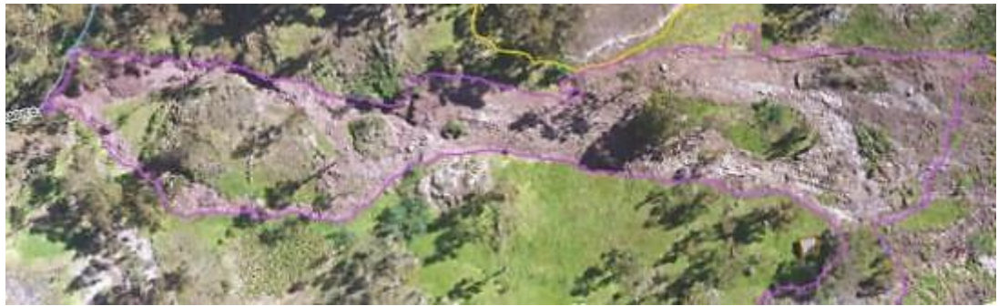
Figura 19. Flujo de detritos (línea morada).
