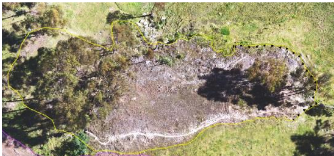
Figura 17. En la imagen se observa una vista en planta del deslizamiento DA2 cuya extensión horizontal es de 30 m.
