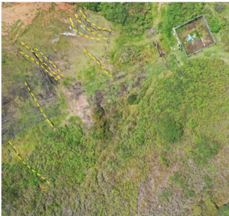
Figura 8. Cuerpo del deslizamiento 01, donde se aprecia la erosión en forma insipiente (en amarillo).
