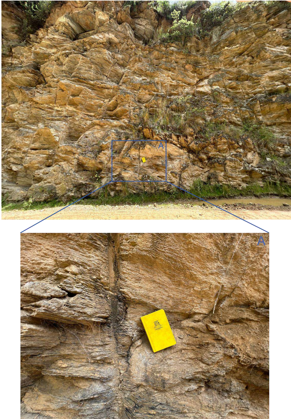
Figura 5. Afloramientos de esquistos de color gris plumizo moderadamente fracturados y meteorizados a la altura del puente Itigaga. Coordenadas WGS 84, 18s, X: 317043 m E; Y: 8914206 m S.
