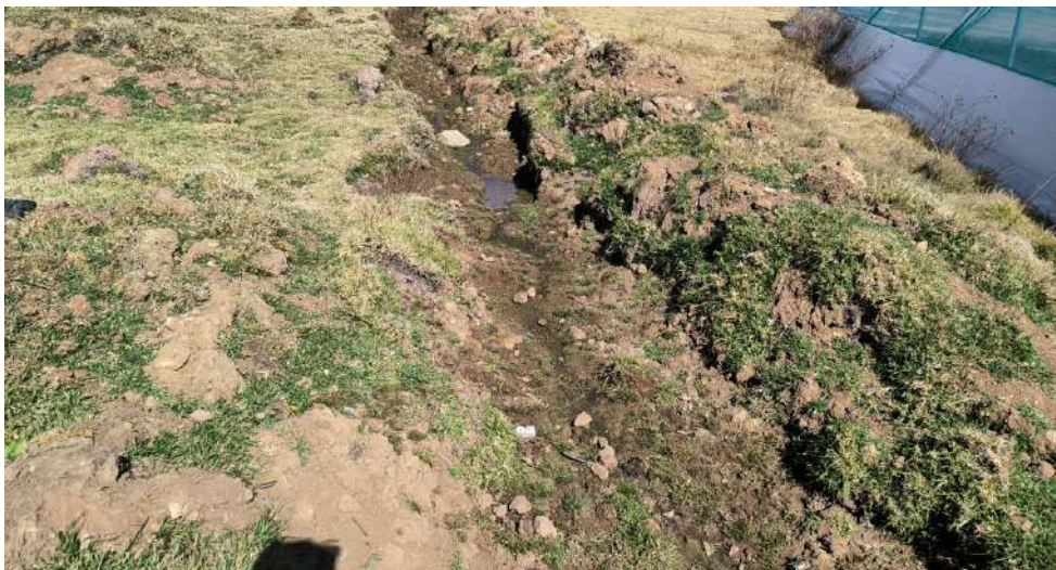
Fotografía 5. Depósitos coluvio deluviales en los terrenos de San Francisco de Cuchicancha, se muestran saturados. .
