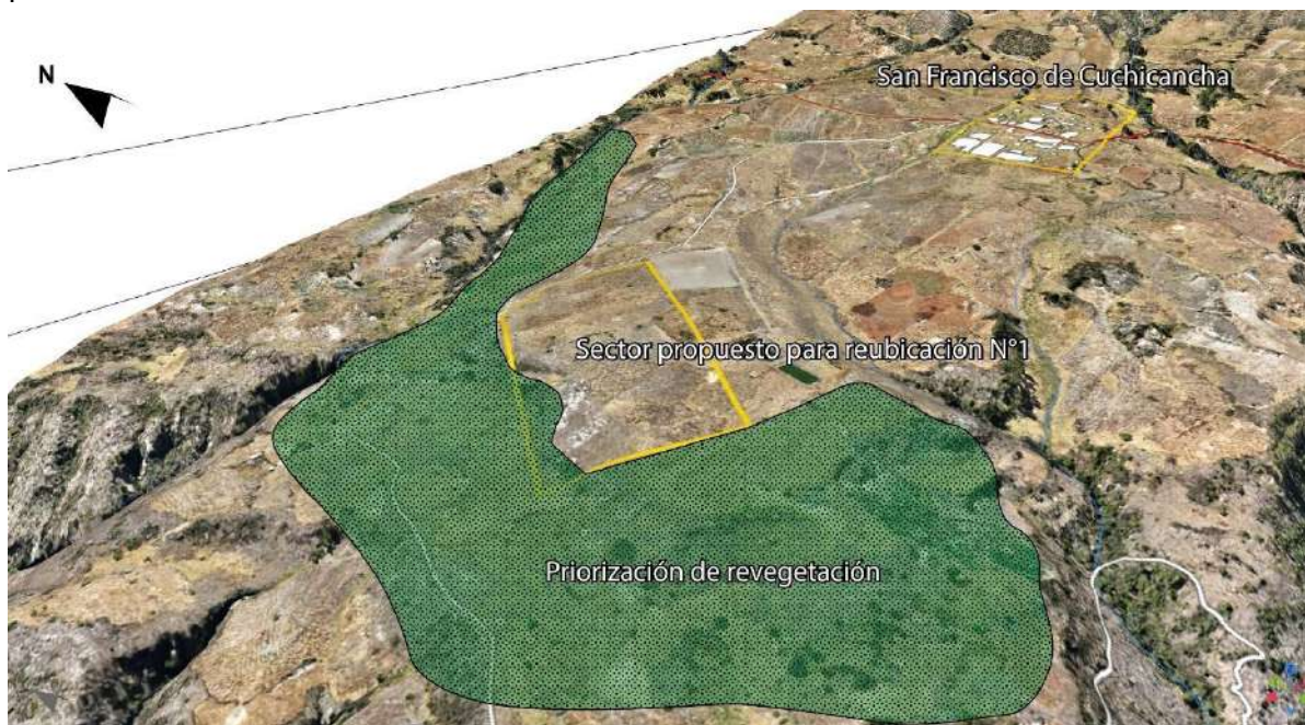
Figura 14. Área de reubicación propuesta N.º 1 y zona que debería priorizarse para reforestación, a fin de prevenir movimientos en masa como el pequeño derrumbe identificado. Asimismo, se recomienda la implementación de sistemas de drenaje.
