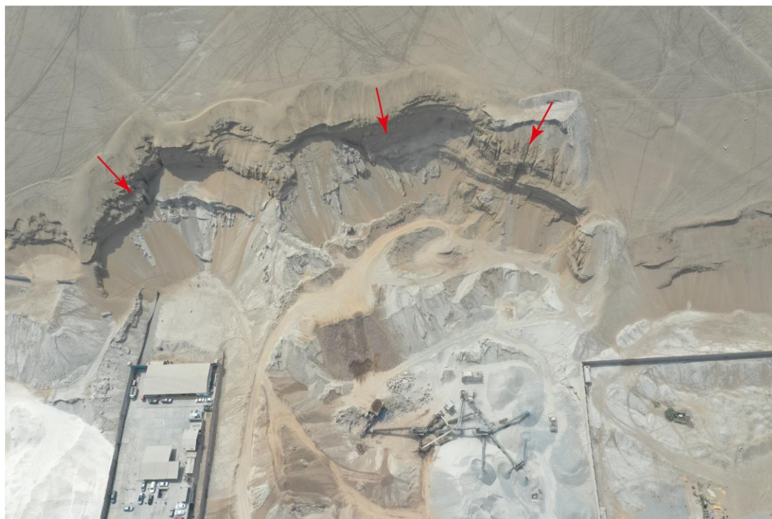
Figura 8. Vista del talud (zona de explotación de arenas), se observa arenas eólicas en aparente estructura estratificada con laminaciones oblicuas, situadas en la parte baja de la ladera de la duna “Lomo de Corvina”.
