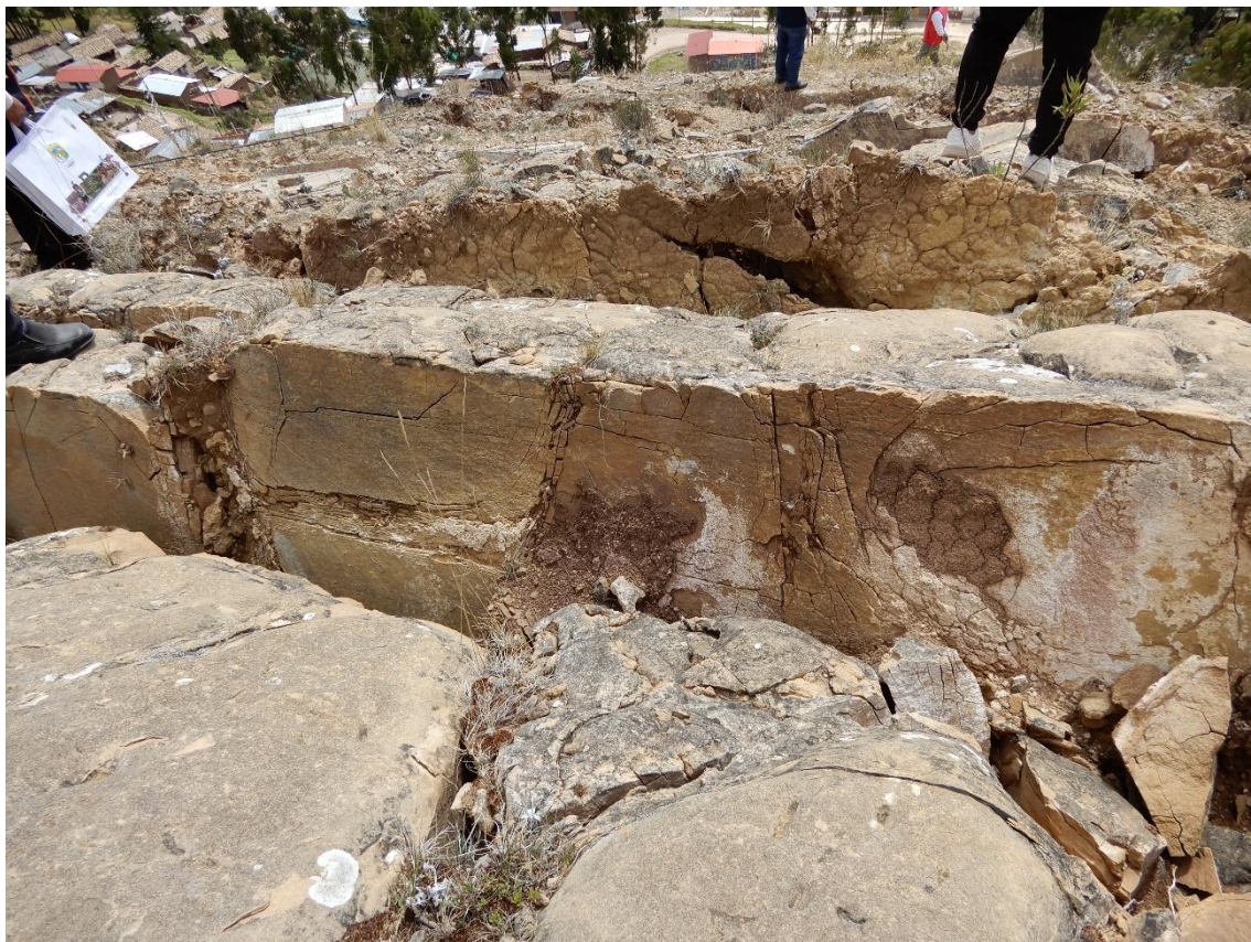
Fotografía 3. Deformación interna del macizo rocoso, que afecto parte de la ladera noroeste del cerro Pucará. Vista ladera abajo.
