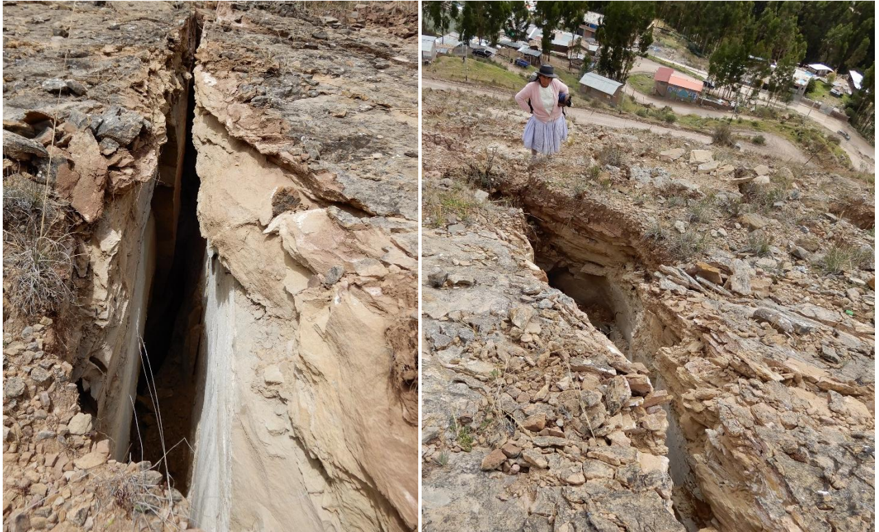
Figura 4. Vista de las aperturas y profundidad de las grietas producidas en la ladera del cerro Pucará.
