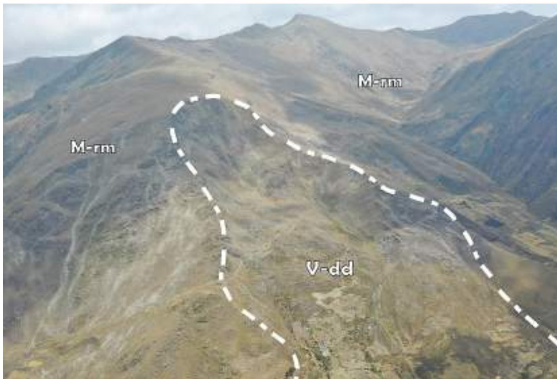
Figura 11. Vista de la subunidad de vertiente con depósito de deslizamiento (V-dd), originado por procesos de movimientos en masa antiguos, resaltando en líneas entrecortadas la escarpa de un deslizamiento antiguo. Ubicación referencial: Al Sureste del Cerro Llama Llama, sector Sogobamba.
