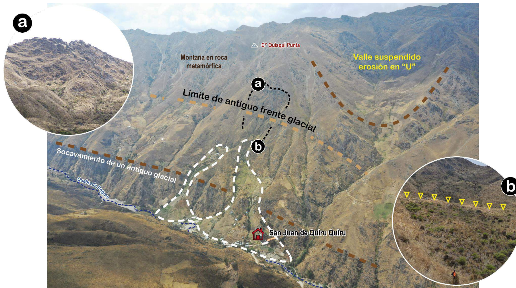
Figura 14. Evidencias geomorfológicas originadas de la dinámica glacial, periglacial y procesos de movimientos en masa que demarcan el relieve actual. a. Procesos de gelifracción (desintegración mecánica de la roca, como consecuencia del aumento de presión del agua congelada contenida en diaclasas, poros y fracturas). b. Escarpes de deslizamiento antiguo condicionado a partir de procesos de erosión, transporte y acumulación del periglacialismo. En líneas entrecortadas blancas se observa el deslizamiento-flujo y sobre el cual se asienta actualmente la población.
