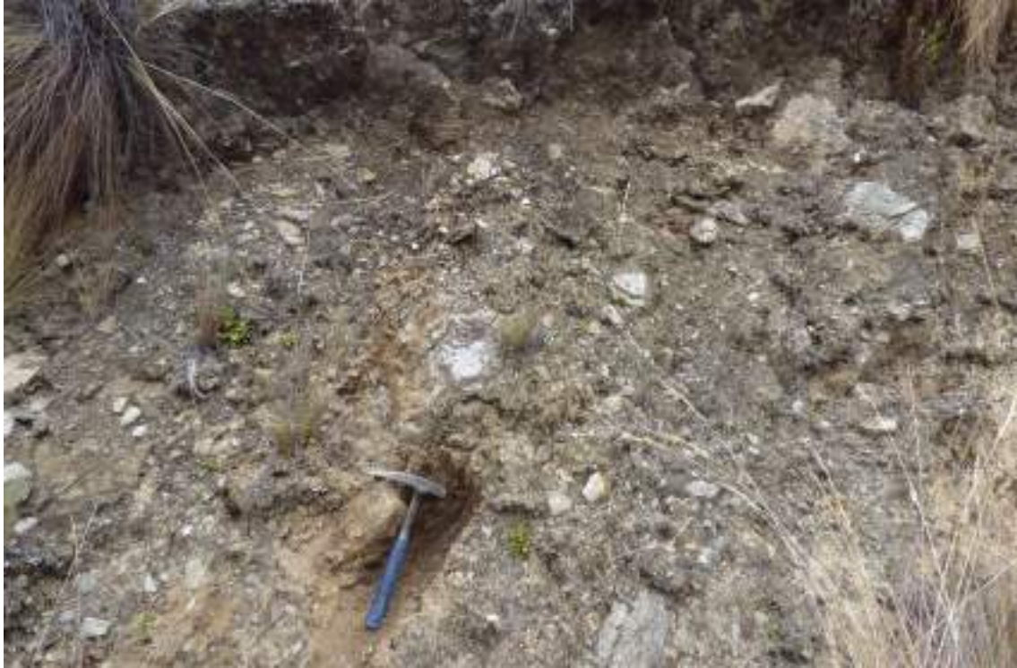
Fotografía 2. Depósito coluvio-deluvial (Q-cd), formado por fragmentos líticos, angulosos a subangulosos, heterométricos, envueltos en matriz arcilloso -limo arenoso. Coordenadas referenciales UTM WGS-84, 18S: E: 320042; N: 8944998 - Caserío de San Juan de Quiru Quiru
