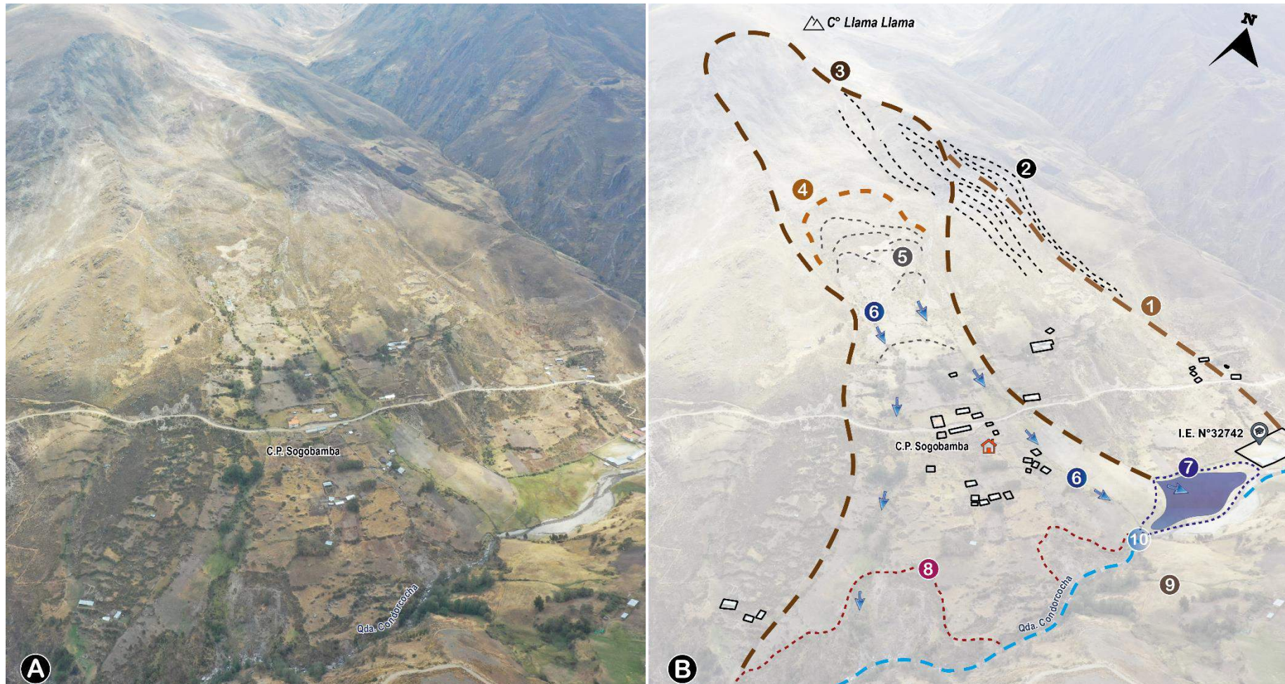
Figura 27: A. Vista panorámica de la ladera sureste del Cerro Llama Llama (centro poblado de Sogobamba). B. Interpretación geodinámica del área de evaluación con las siguientes características: 1. Límite de deslizamiento antiguo. 2. Reactivaciones antiguas. 3. Límite del deslizamiento-flujo. 4. Reactivaciones posteriores. 5. Agrietamientos recientes. 6. Surgencias e infiltraciones de agua (las flechas azules indican las redes de flujo). 7. Bofedales de agua en la zona de embalse plana o valle represado. 8. Derrumbes activos al pie de la ladera. 9. Depósito de “run up” del deslizamiento antiguo en la margen contigua del valle. 10. Inicio zona de desembalse antiguo y tramo de erosión fluvial que generó la profundización del cauce y derrumbes en ambas márgenes.
