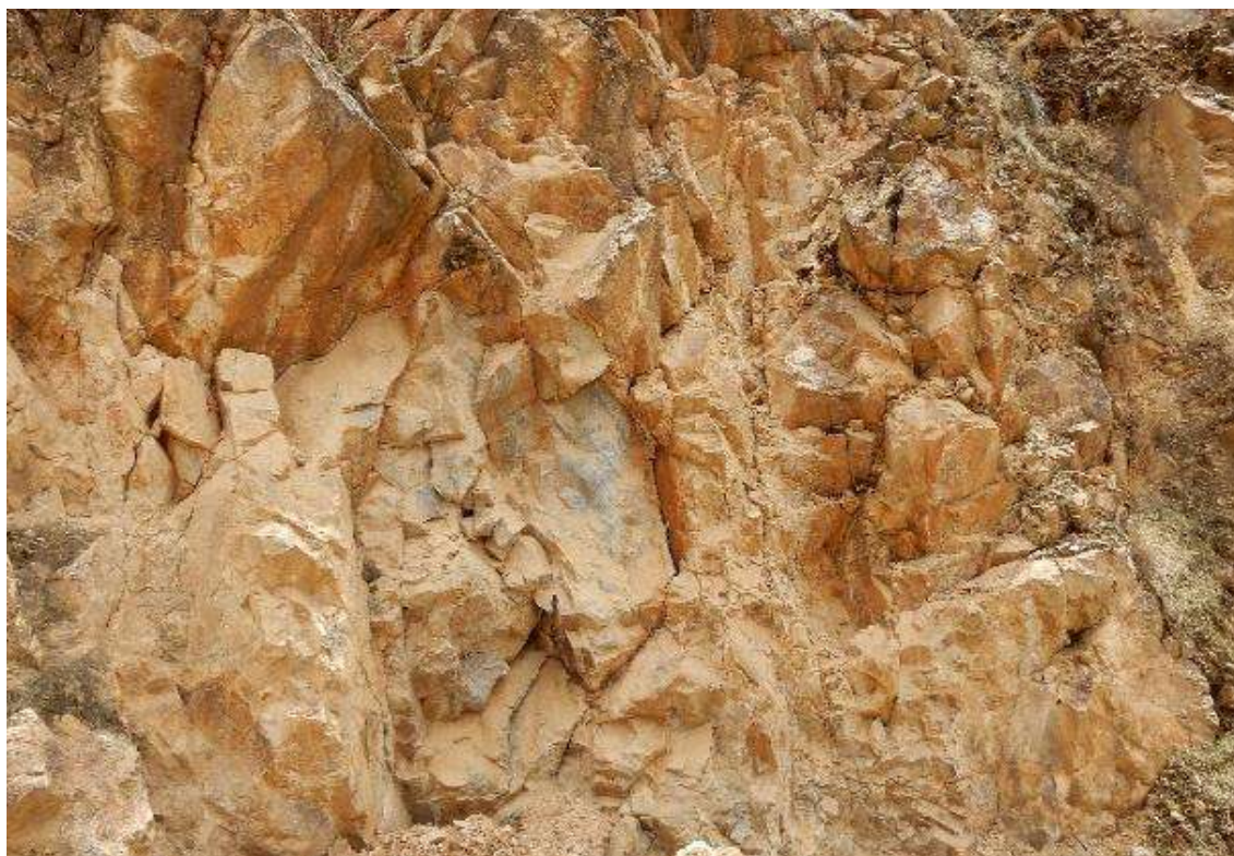
Fotografía 4. Las granodioritas y tonalitas de la Unidad Tupe se presentan altamente meteorizada y de mediana a muy fracturadas
