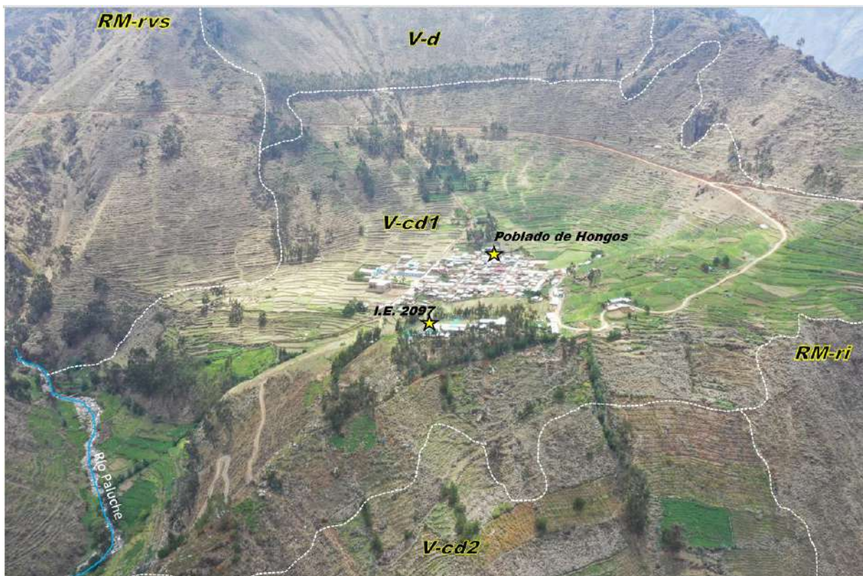
Figura 5. Unidades geomorfológicas expuestas en el poblado de Hongos. RE-rvs. Montaña en roca vulcano sedimentaria, RM-ri: Montaña en roca intrusiva, V-co: Vertiente coluvial y V-d: Vertiente deluvial.
