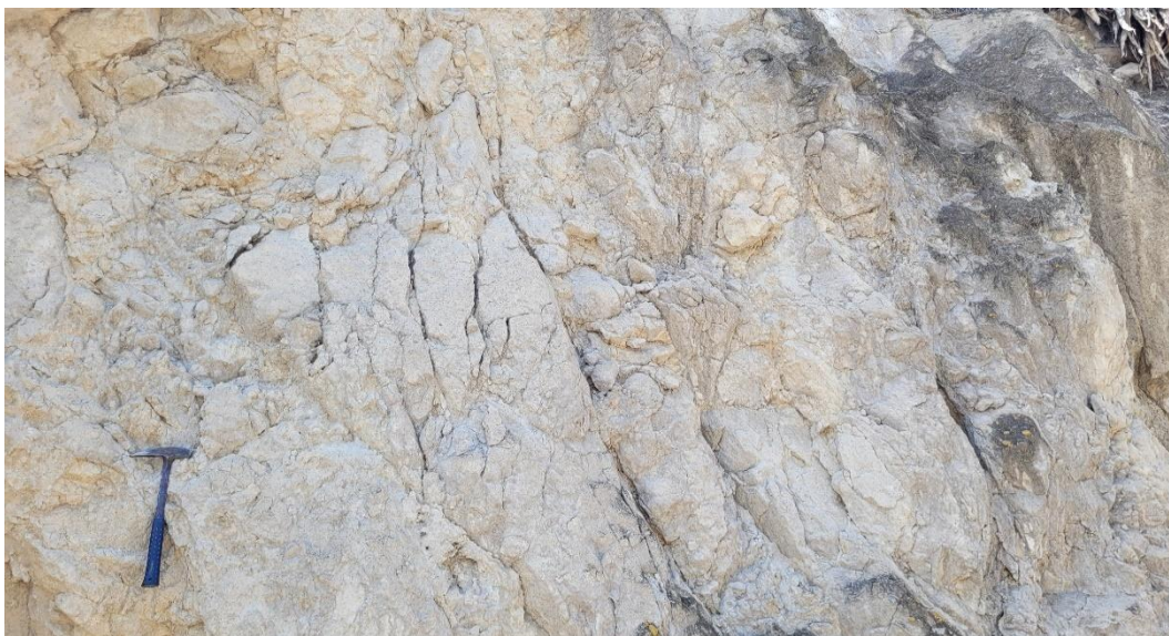
Fotografía 1. Se observa traquita volcánica, compuesta por plagioclasas y sanidina, el macizo se encuentra medianamente a muy fracturado y moderadamente meteorizado, La roca a simple vista se aprecia muy susceptible a la descomposición o meteorización física y química.
