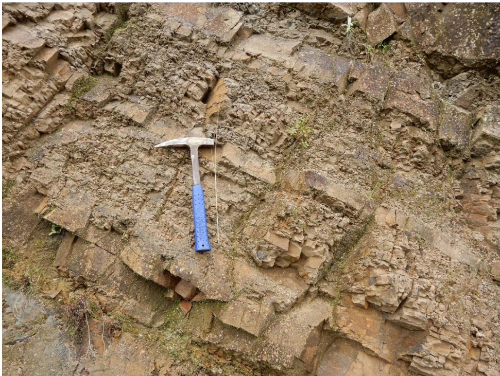
Fotografía 2. Detalle de las rocas aflorantes en el sector Pampamarca. Nótese el grado de fracturamiento y meteorización del macizo rocoso atribuida al Grupo Ambo.
