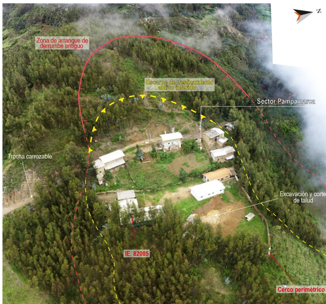
Figura 9. Cartografía de movimiento en masa en el sector Pampamarca. Se observa el deslizamiento activo que afecta parte de la población y la I.E. N°82005.
