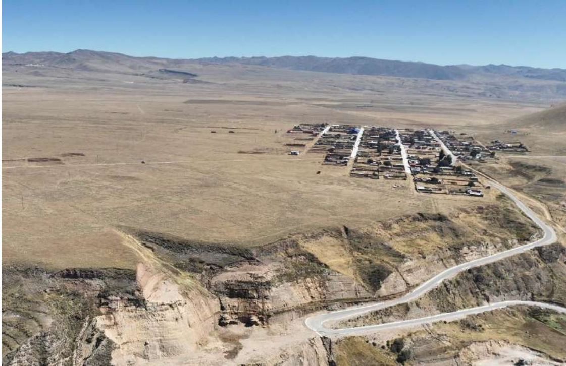
Fotografía 5. Vista de terraza de origen fluvio-glaciar, que forma la extensa planicie de Huaripuquio y sobre la cual se asienta el sector de Vista Alegre. Sobre esta unidad geomorfológica se desarrolla procesos de erosión en cárcavas y deslizamientos activos.
