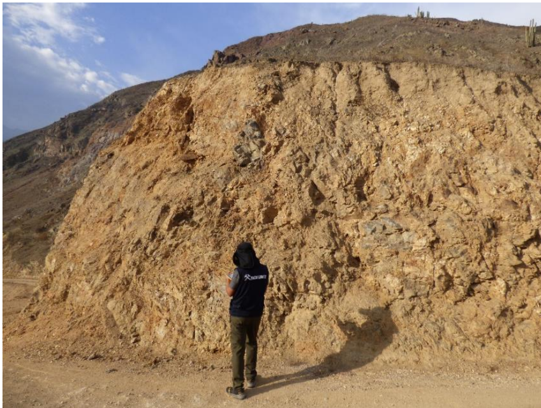
Fotografía 2. Macizo rocoso ubicado en la ladera media superior del cerro Jaracoto, se observa en estructura masiva con aspecto triturado y fragmentado con una superficie fuertemente meteorizada (E: 278232, N: 8787382). Vista mirando al norte.
