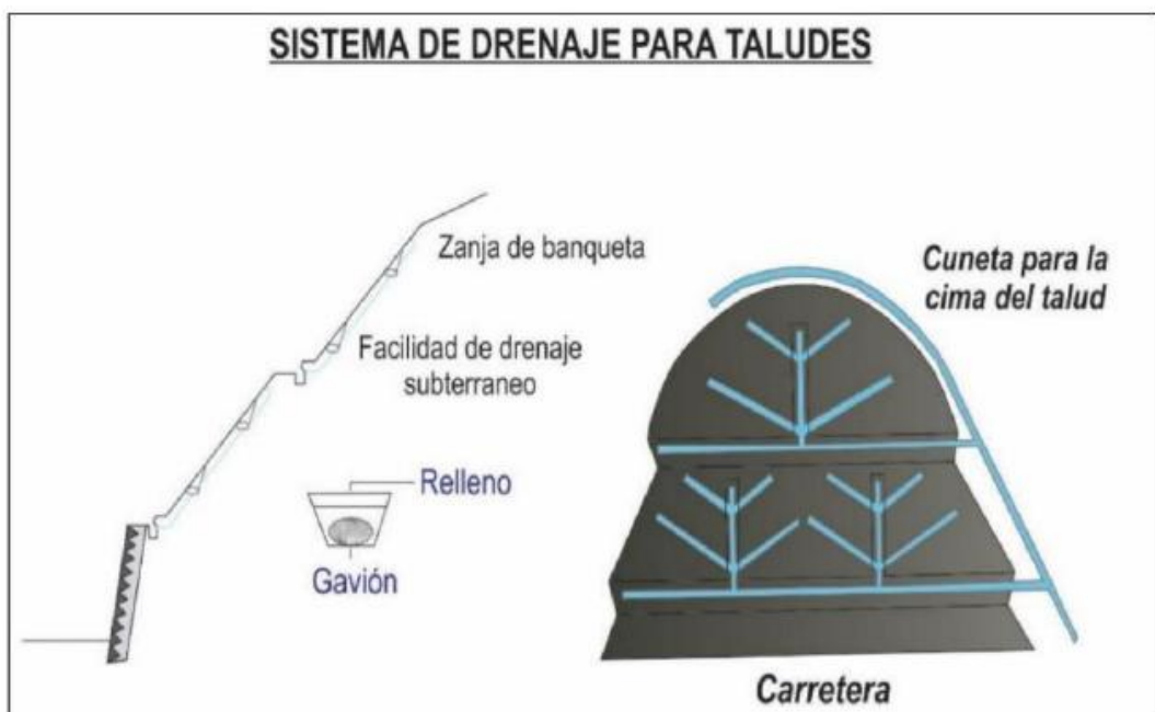
Figura 20. Drenaje tipo espina de pescado. Tomado de INGEMMET (2000).
