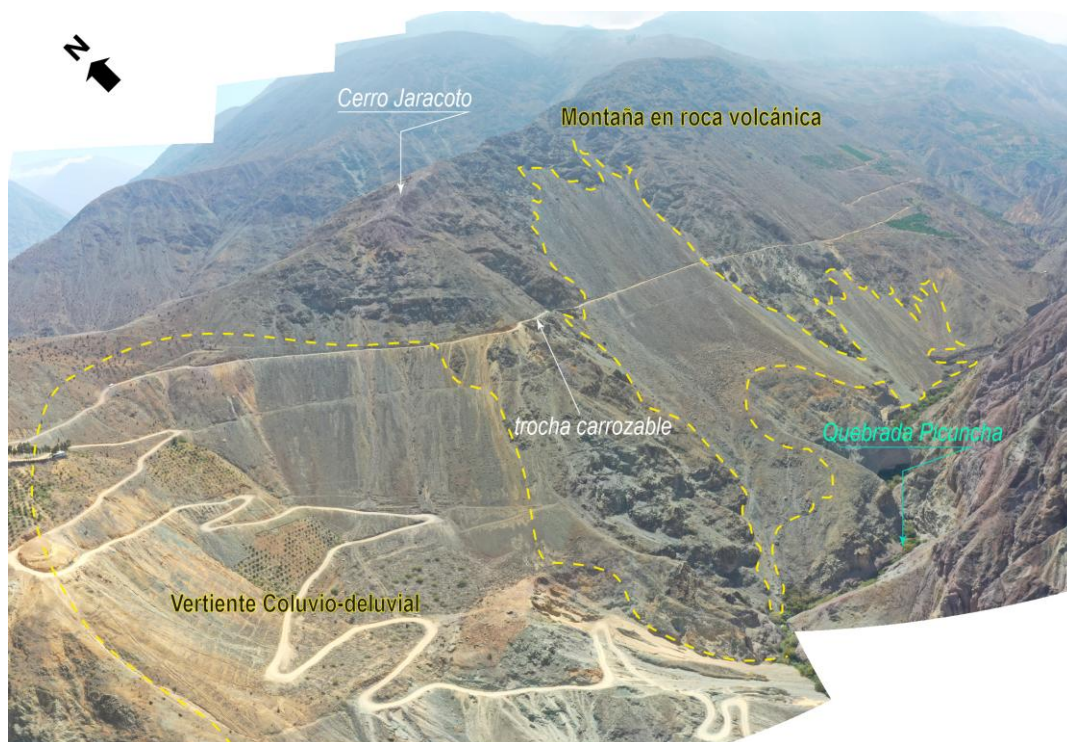
Figura 9. Unidades geomorfológicas resultado de la actividad geológica y geodinámica pasada en la ladera occidental del cerro Jaracoto del sector Muzga. Montaña en roca volcánica y Vertiente coluvio-deluvial. Vista mirando al noreste.
