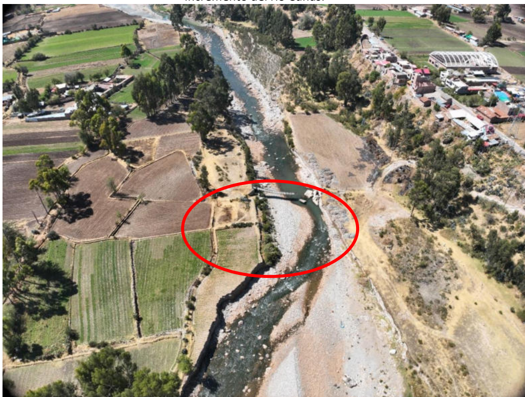
Imagen N° 35: Se evidencia un puente colgante colapsado a consecuencia del incremento del río Cunas.
