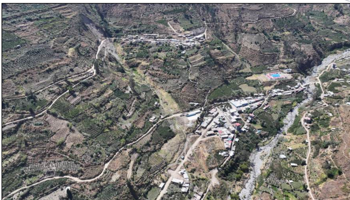
Foto 12: En la zona de deslizamiento se observa una gran variedad de terrenos de cultivo que emplean sistemas de riego por gravedad, principalmente mediante inundación de parcelas. Estas prácticas contribuyen a la saturación del suelo, reduciendo su cohesión y estabilidad, lo que incrementa la susceptibilidad a avalancha de detritos en la zona.
