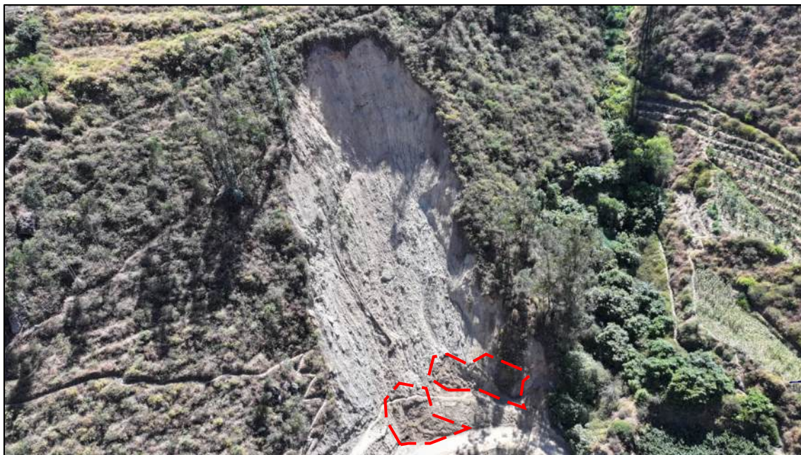
Foto 11: Acercamiento del escarpe generado por la avalancha de detritos registrada en abril de 2023, donde se observan actualmente zonas húmedas con presencia de puquiales que indican filtraciones permanentes en el terreno.
