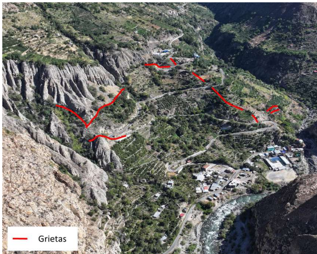
Foto 9: Imagen capturada con dron, en la que se evidencian el escarpe y las grietas identificadas en el área de estudio.
