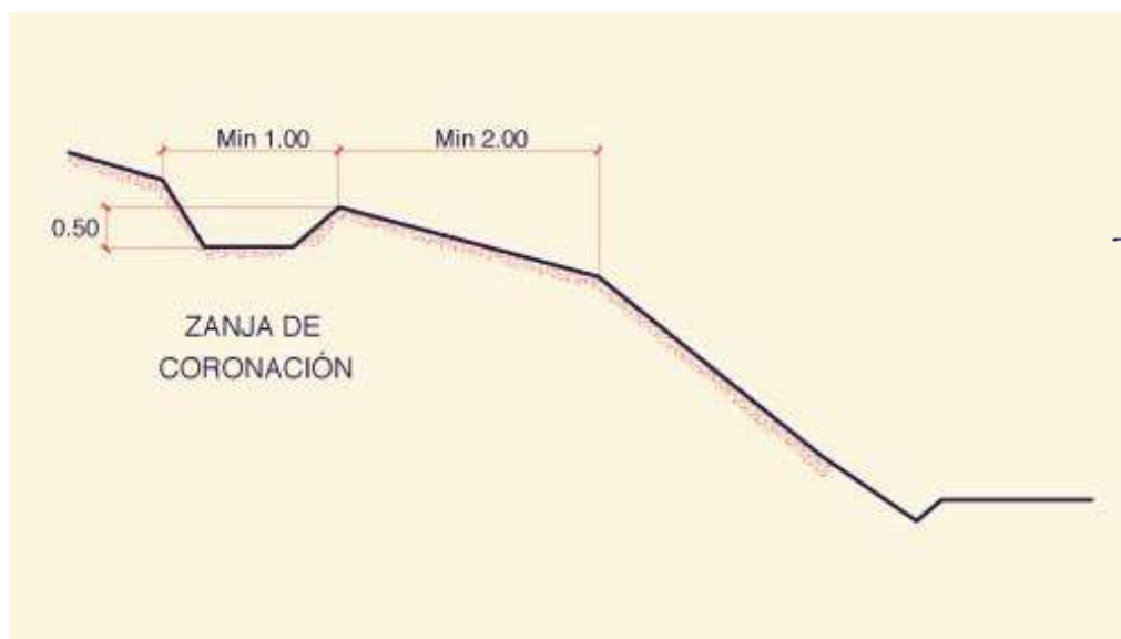
Figura 14: Detalle de una canaleta de un drenaje superficial (zanja de coronación)
