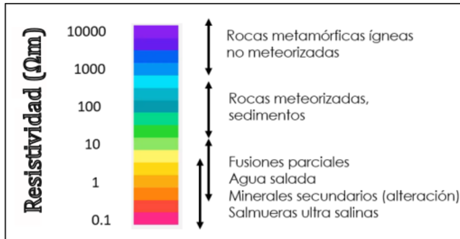
Figura 3.- Resistividad eléctrica de los materiales terrestres (Fuente: modificado de Simpson y Bahr, 2005). Los rangos de valores se muestran en forma de barras y están coloreados en azul para la resistividad alta y en rojo para la resistividad baja (conductiva).
