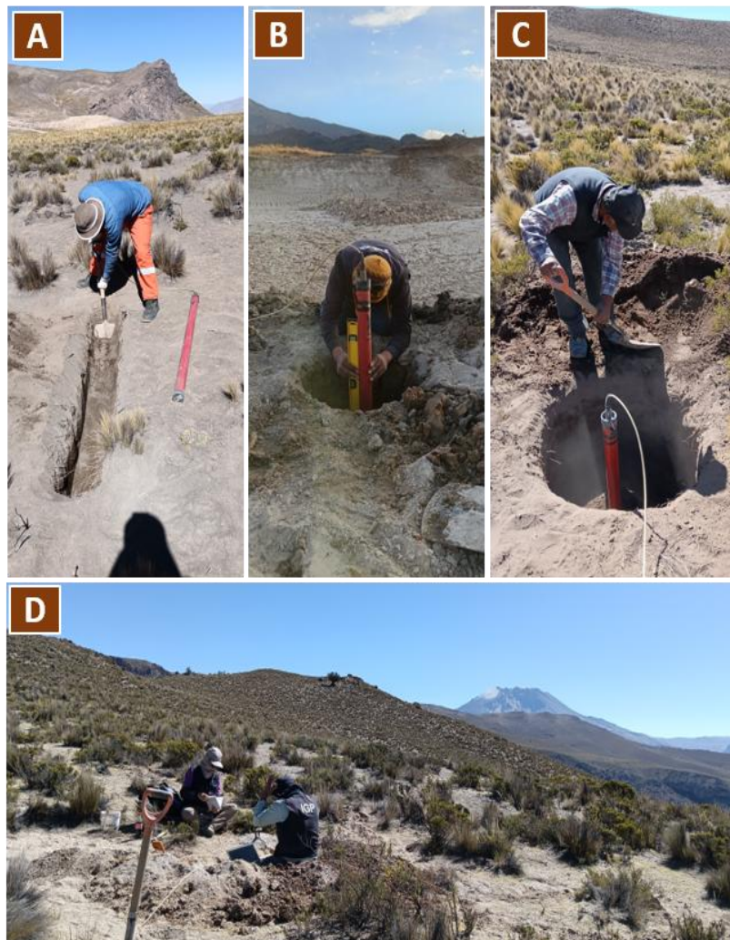
Figura 10.- Imágenes del trabajo de realizado en la segunda campaña. A) Instalación del sensor magnético horizontal ( H_x , H_y ). B) y C) Instalación del sensor magnético vertical ( H_z ). D) Vista panorámica donde se realiza la prueba de operatividad de la estación MT y de fondo se observa al volcán Ubinas.
