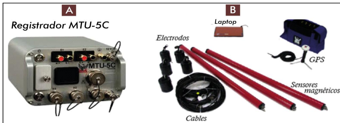
Figura 9.- Equipo magnetotelúrico con registrador MTU-5C (A) y accesorios completos (B) utilizado en el registro de datos MT durante la segunda campaña de campo en el volcán Ubinas (Fuente: Phoenix Geophysics Ltd.).
