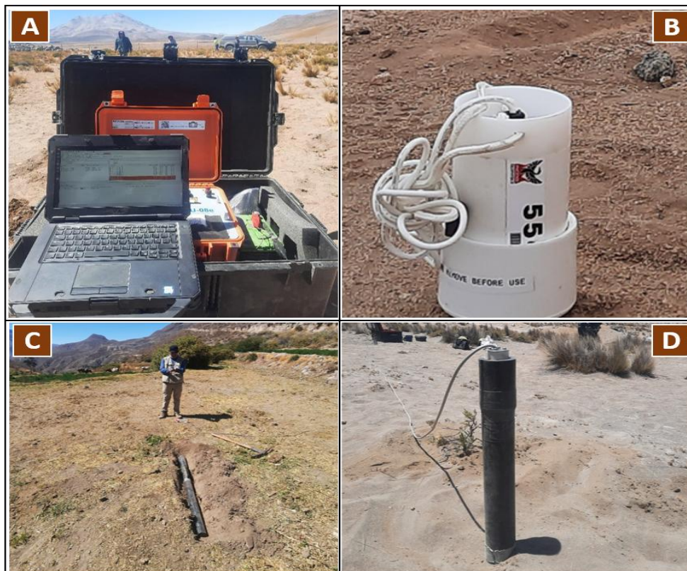
Figura 8.- Fotografías de la primera campaña de campo donde se muestra la instalación del equipo magnetotelúrico. A) Instrumento Metronix y ordenador portátil utilizado para la adquisición de datos. B) Electrodo porosos. C) Bobinas de inducción magnética para los componentes H_x , H_y . D) Bobina de inducción magnética para el componente H_z .
