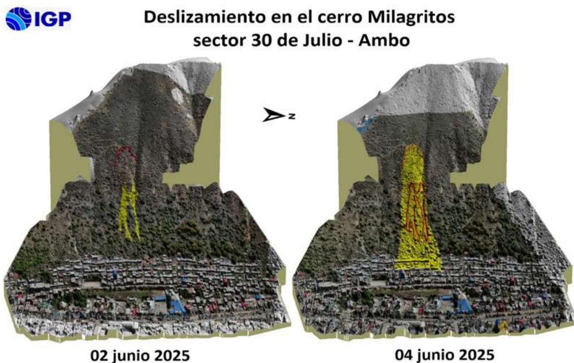
Figura 26. El 2 de junio ocurrió un primer deslizamiento (figura izquierda); la mancha amarilla indica el material deslizado. En la imagen de la derecha se ilustra el deslizamiento en su totalidad, ocurrido el 4 de junio.
