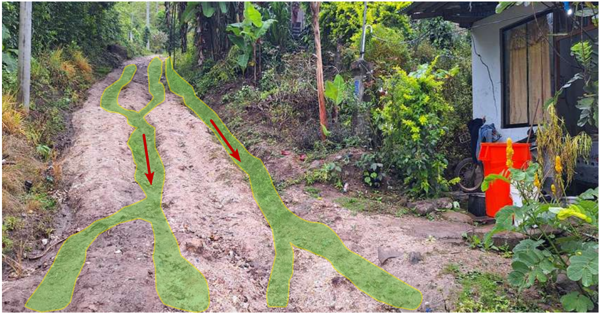
Figura 24. Cárcavas formadas por erosión de ladera, ubicadas en una calle del caserío Progreso. La flecha roja indica la dirección de la escorrentía.
