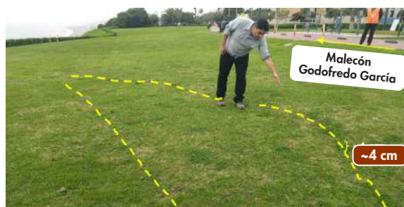
Figura 12. Asentamiento aproximado de 4 cm, asociado a zonas con presencia de saturación, identificado al sur del parque Mahatma Gandhi, sobre material de relleno colmatado correspondiente a una antigua quebrada (punto 4 en la Figura 8).
