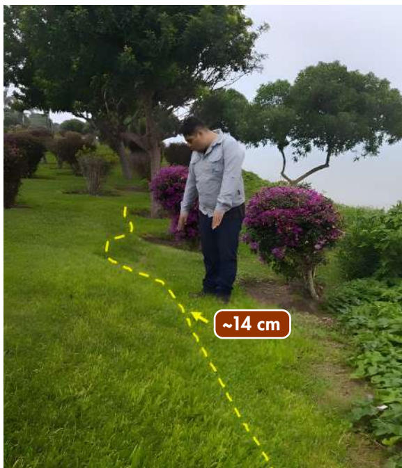
Figura 9. Escarpe de aproximadamente 14 cm de desnivel frente al parque Benemérita Guardia Civil.
