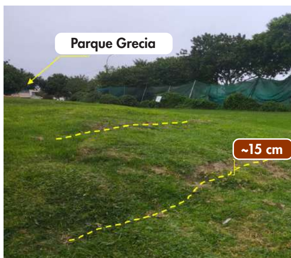
Figura 13. Presencia de escarpe de ~15 cm de desnivel, frente al parque Grecia (punto 5 en la Figura 8).
