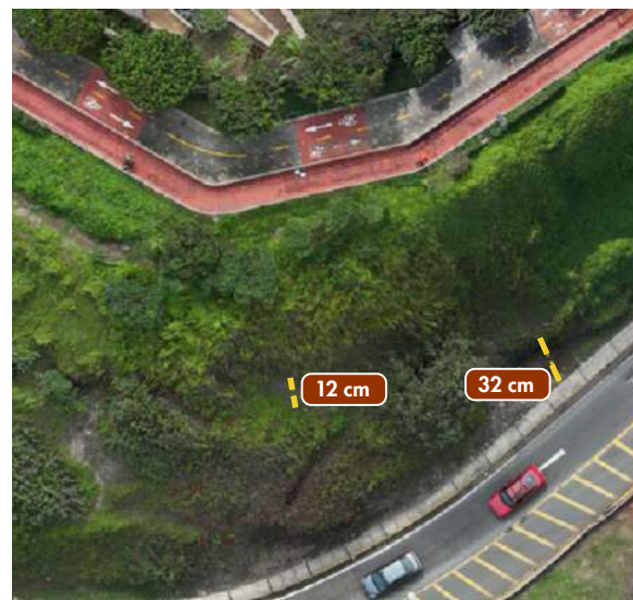
Figura 14. Desprendimientos localizados con magnitudes de hasta 32 cm, observados en el talud ubicado frente al parque Bicentenario (punto 6 en la Figura 8).
