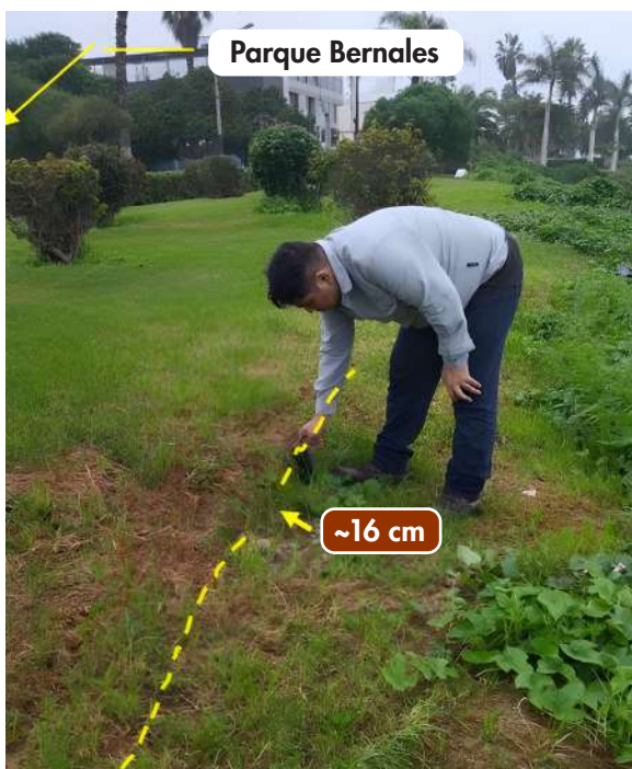
Figura 10. Asentamiento aproximado de 16 cm, localizado en las inmediaciones del acantilado, frente al parque Bernales.
