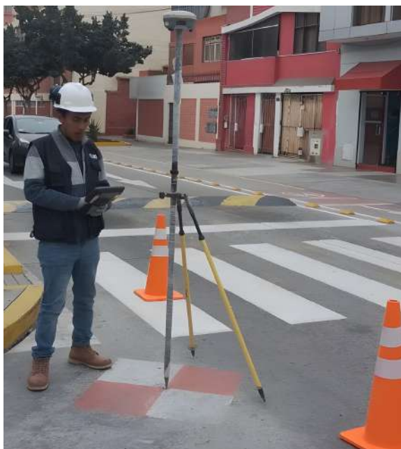
Figura 4. Medición del punto de control en el distrito de San Isidro en la Av. Pérez Araníbar. Se observa al operador y al equipo rover R8S-Trimble sobre una marca diana.
