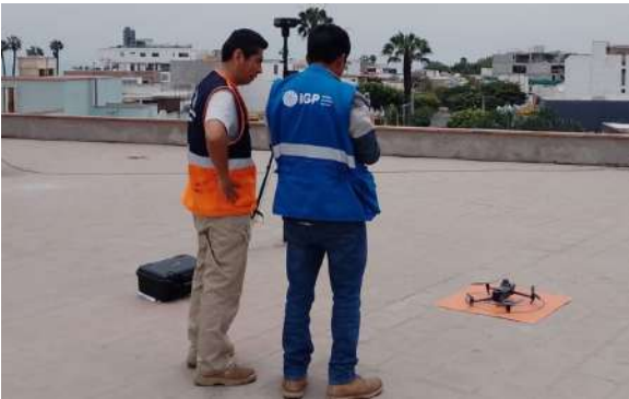
Figura 2. Ejecución de los vuelos fotogramétricos con dron Mavic 3M. Zona de despegue y aterrizaje ubicada en el techo del edificio de Seguridad Ciudadana de la Municipalidad de San Isidro.
