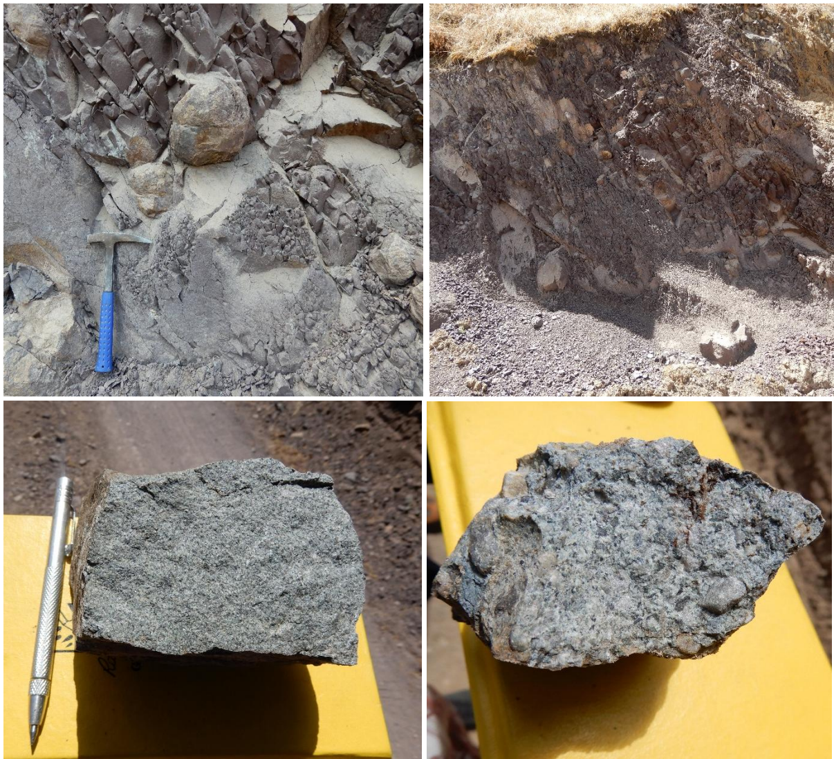
Figura 3. Vista del afloramiento rocoso de composición volcánica y subvolcánica. Se presentan muy fracturadas y altamente meteorizadas.
