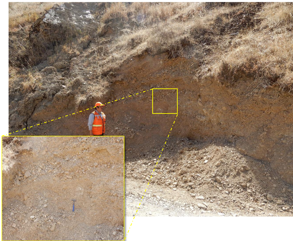
Figura 4. Depósito coluvio deluvial acumulado al pie de la ladera debido a la ocurrencia de procesos de movimientos en masa antiguos.
