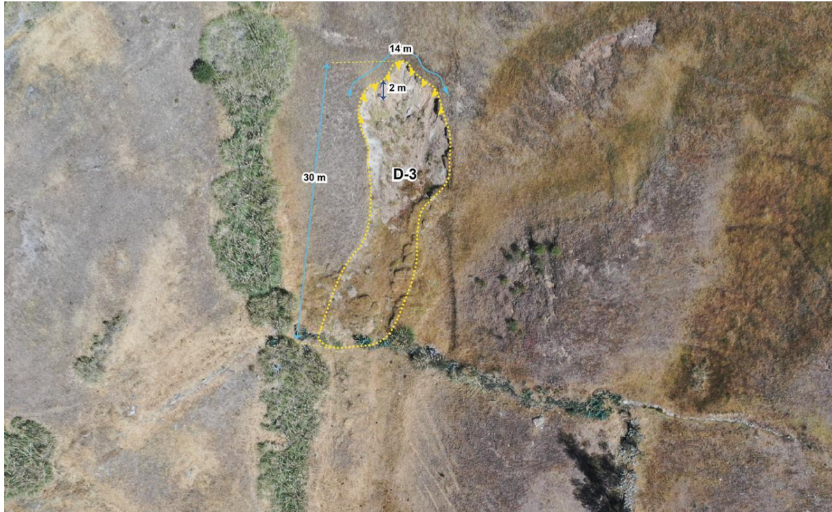
Figura 19. Vista de dimensiones generales del deslizamiento D-3, el cual afecta terrenos de pastizales.
