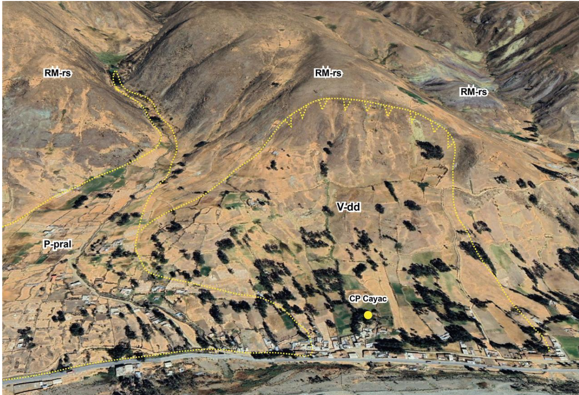
Figura 8. Vista de la subunidad de relieve de montaña en roca sedimentaria (RM-rs), cuyas laderas presentan pendientes fuertes a muy fuerte (15°- 45°), Vertiente con depósito de deslizamiento (V-dd).
