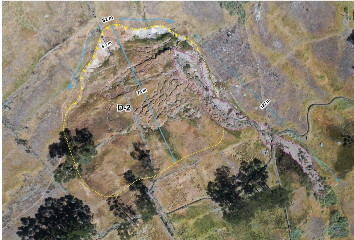
Figura 16. Dimensiones del deslizamiento D-2 el cual afectó principalmente áreas de pastizales ubicadas en la zona
