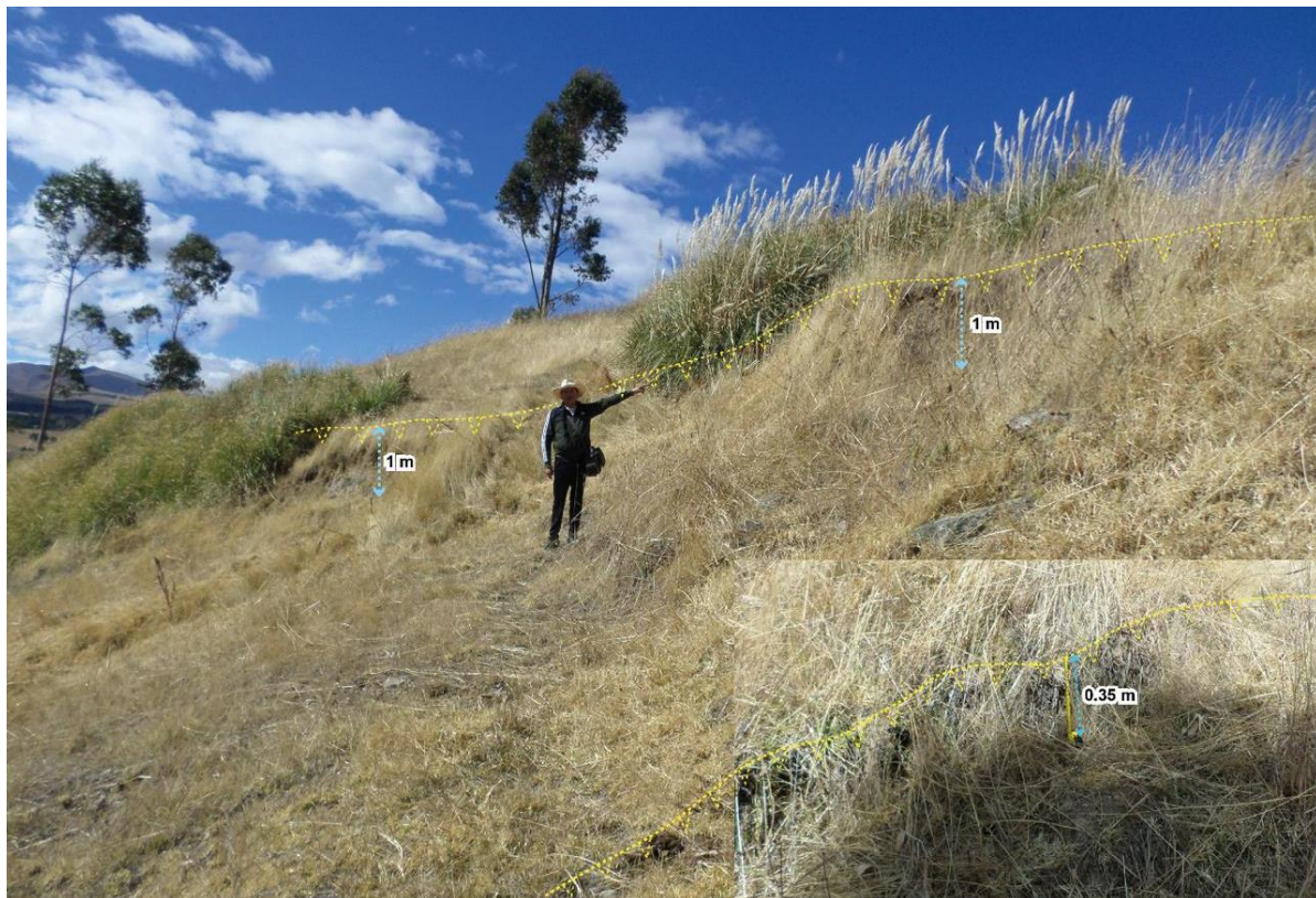
Figura 13. Vista de escarpes antiguos con saltos de 0.35 m a 1 m ubicados en el flanco izquierdo del deslizamiento D-1.
