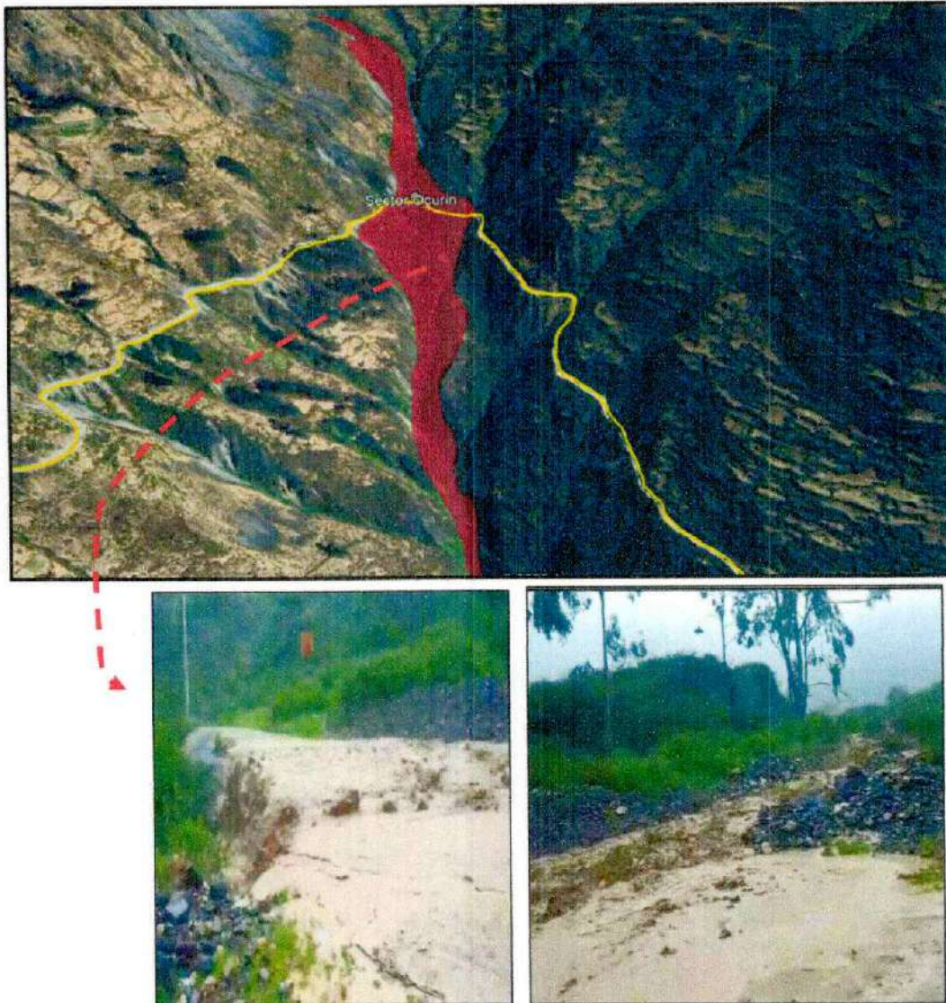
Figura N° 42. Zona critica Quebrada Mansa Huarmi, presenta flujo de detritos
