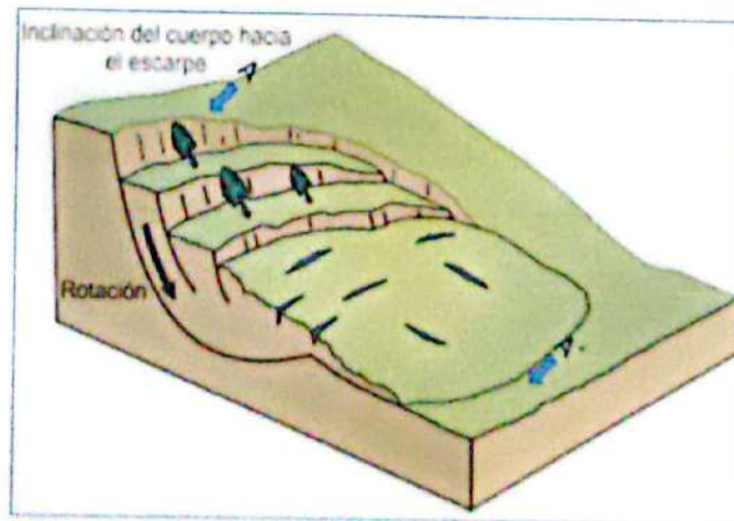
Ilustración 7. Esquema de un Deslizamiento
