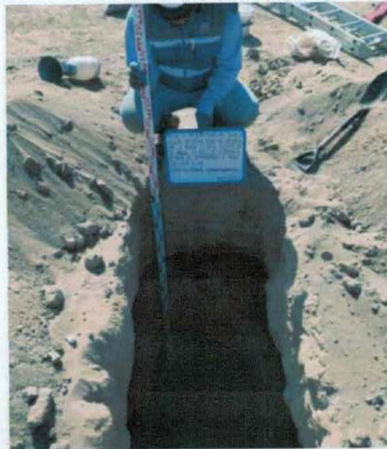
Gráfico N° 6. Calicata N°01 resultado del material natural de EMS
