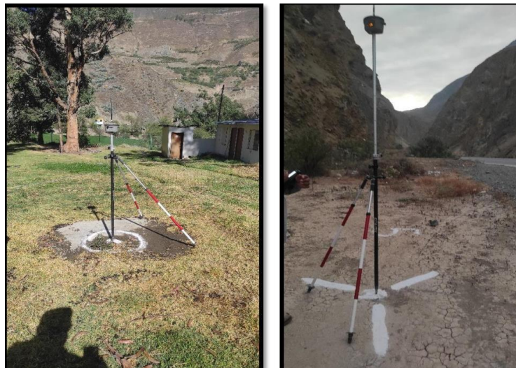
Figura 5: Puntos de Fotocontrol Pre marcado.
