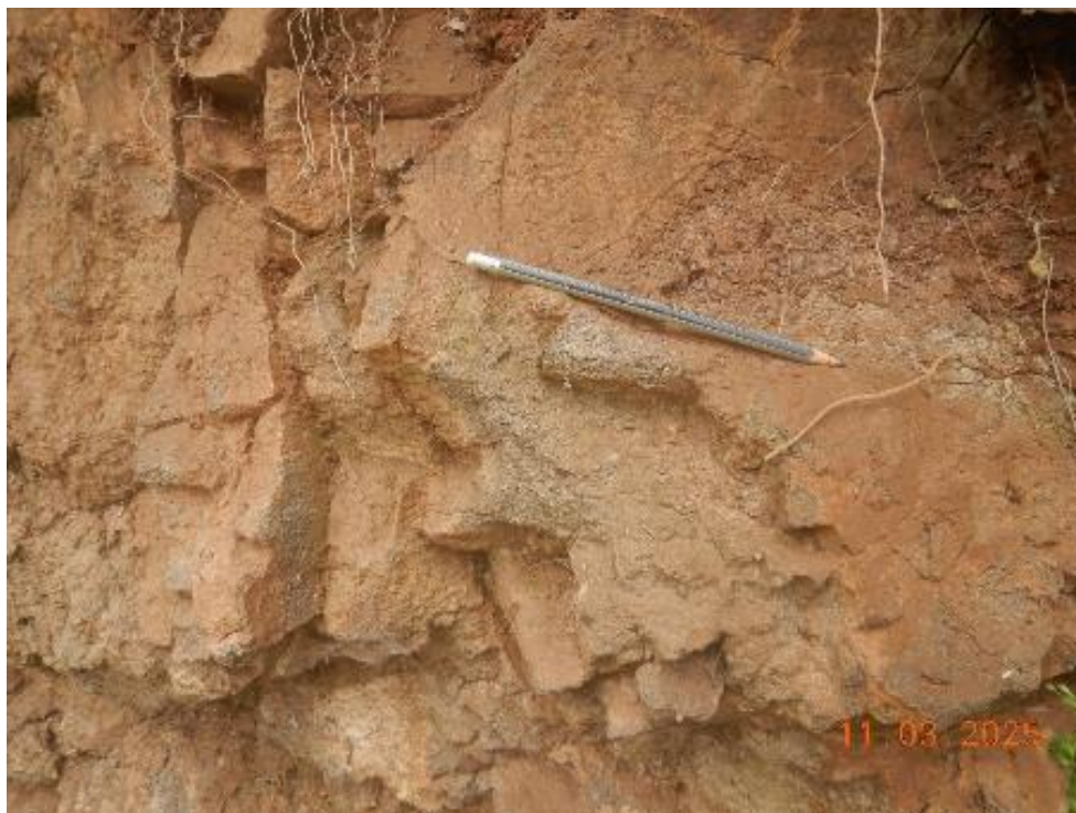
Fotografía 1: Micro conglomerados con clastos volcánicos característico de la Formación Kayra. Estas rocas se muestran muy fracturados y moderadamente meteorizadas.
