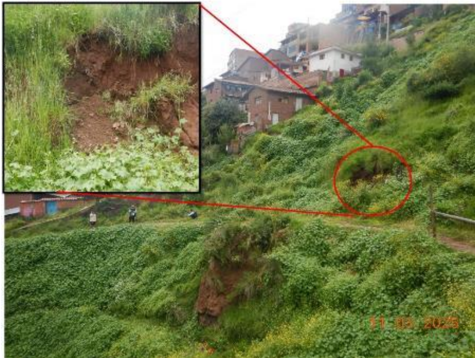
Figura 4: Depósito coluvio - deluvial compuesto por gravas envueltas en matriz arcillo areno limosa.
