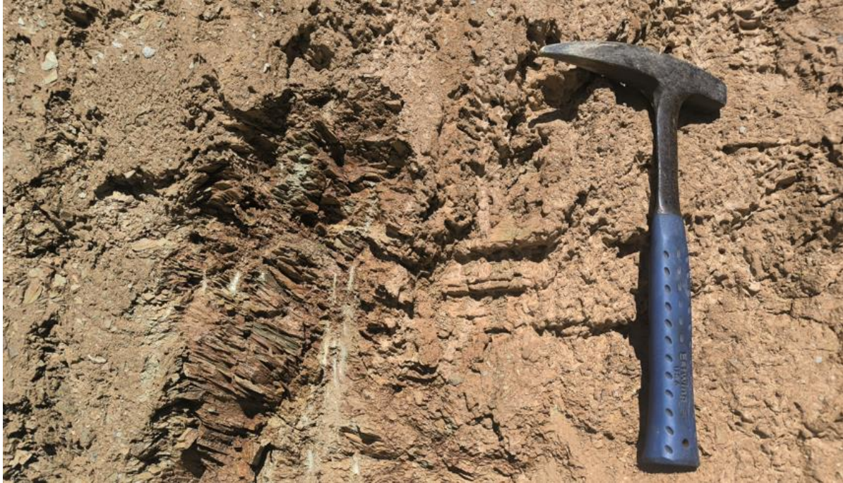
Fotografía 1. Lutitas del Grupo Cabanillas visibles en los cortes del Talud, para la construcción del reservorio de agua en el sector Tororumi.
