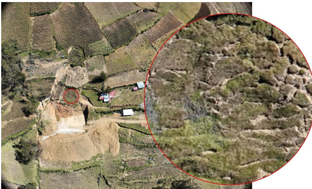
Figura 8 . Agrietamientos longitudinales en el cuerpo del deslizamiento.
