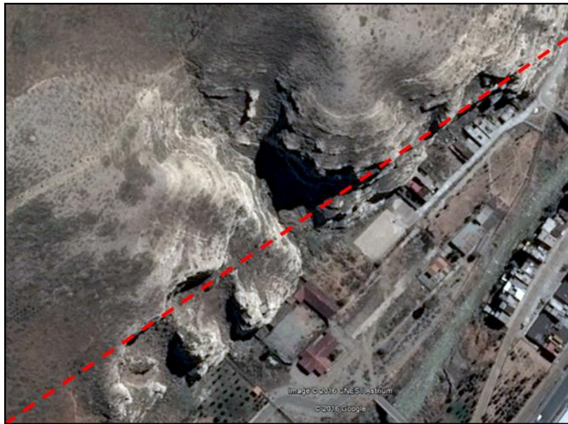
Foto 2 Presencia de falla, con tendencia NE/SO
