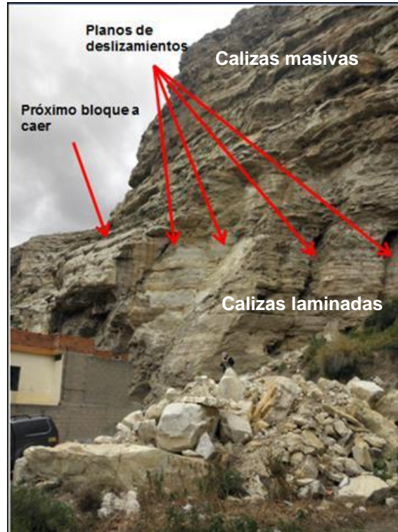
Foto 6 Se muestra los diversos planos de caídas más los bloques removidos después del deslizamiento.
