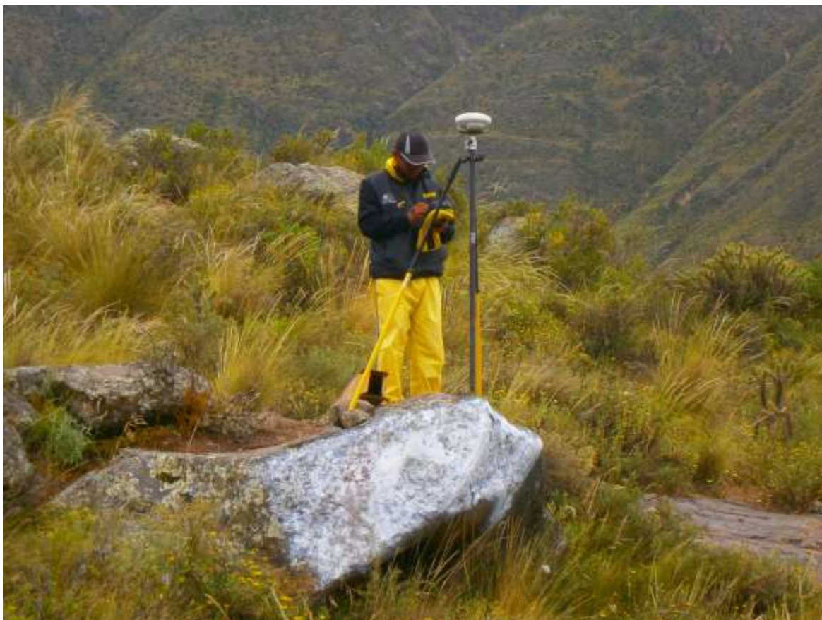
Figura 4. Lectura con GPS diferencial en un punto de referencia para la georreferenciación de las imágenes LiDAR.
