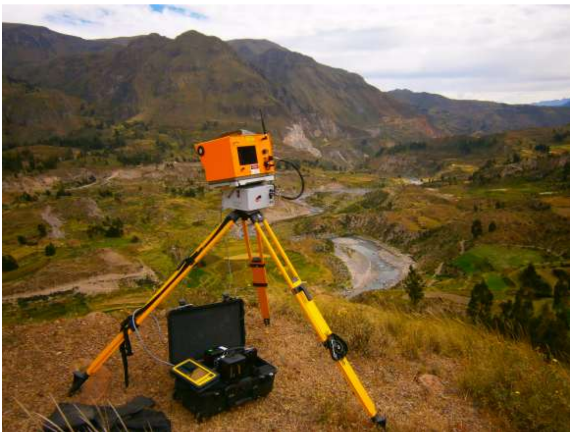
Figura 1. Escáner LiDAR marca OPTECH modelo ILRIS-LR instalada en la base MAB3, mientras se escanea los escarpes del deslizamiento de Maca.
