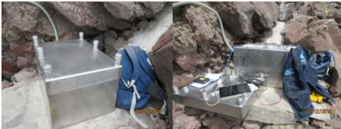
Figura 2.1. Construcción de la caseta de seguridad y mantenimiento de la estación sísmica MST01.
