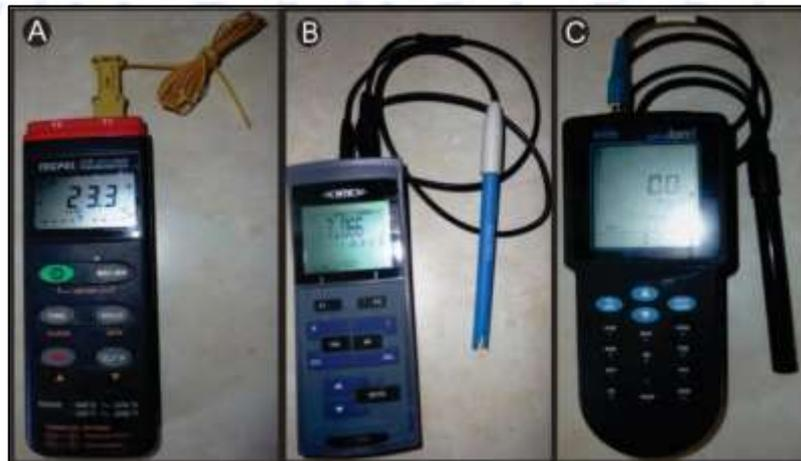
**Figura 3.5** Equipos utilizados en el monitoreo geoquímico (A) Termómetro TECPEL, (B) pH-metro WTW, (C) Conductímetro HACH.
