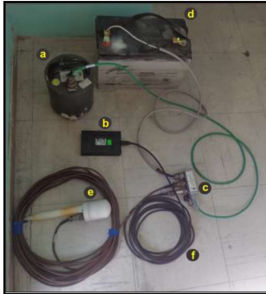
Figura 2.1.2 (a) Sensor sísmico GURALP modelo CMG – 6TD. (b) Disco externo. (c) Caja de conexiones externas (Breakout box), (d) Batería (Fuente de energía). (e) GPS. (f) Cable de conexión entre el disco externo y el sensor.
