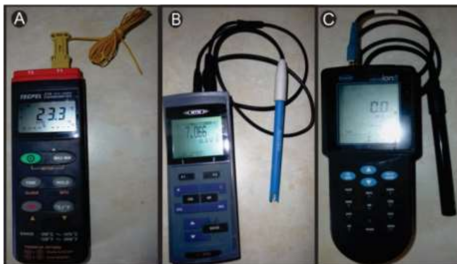
Figura. 2.2.3. Equipos utilizados en el monitoreo geoquímico (A) Termómetro TECPEL, (B) pH-metro WTW, (C) Conductímetro HACH.
