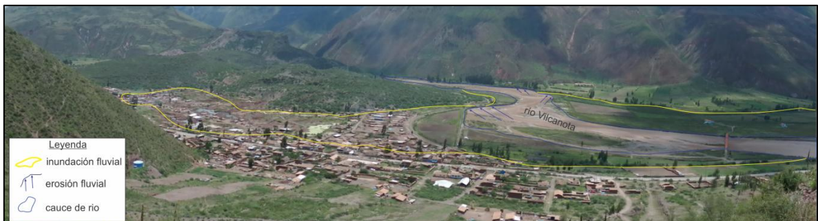
Foto 7. Vista de la llanura inundable (line amarillo) y zona de erosión fluvial en ambas márgenes del río Vilcanota en las inmediaciones del poblado de Piñipampa (línea Azul).
