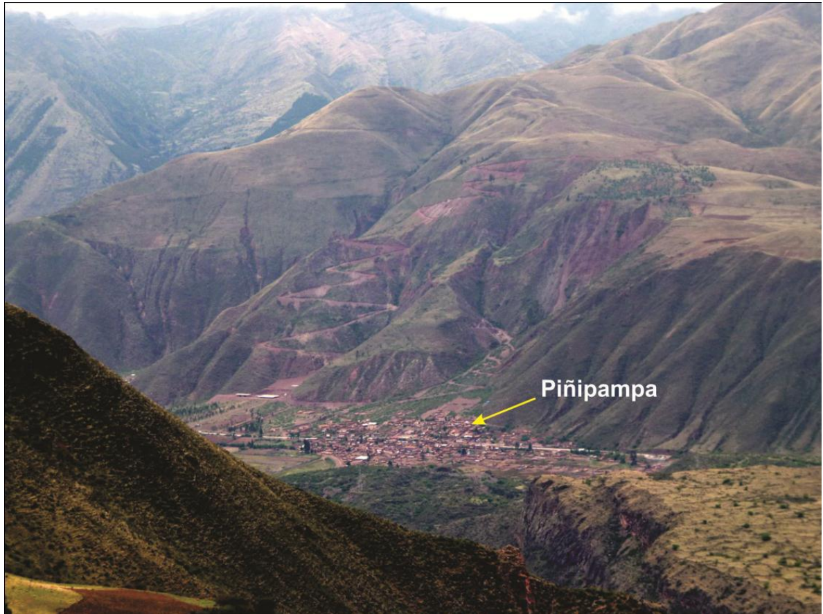
Foto 4. Vista panorámica donde se puede observar las viviendas del poblado de Piñipampa asentadas sobre el cono proluvial de la quebrada Sacrahuaycco, también se observa la zona de derrumbes activos en la cuenta alta de la quebrada, Vilchez (2015)
