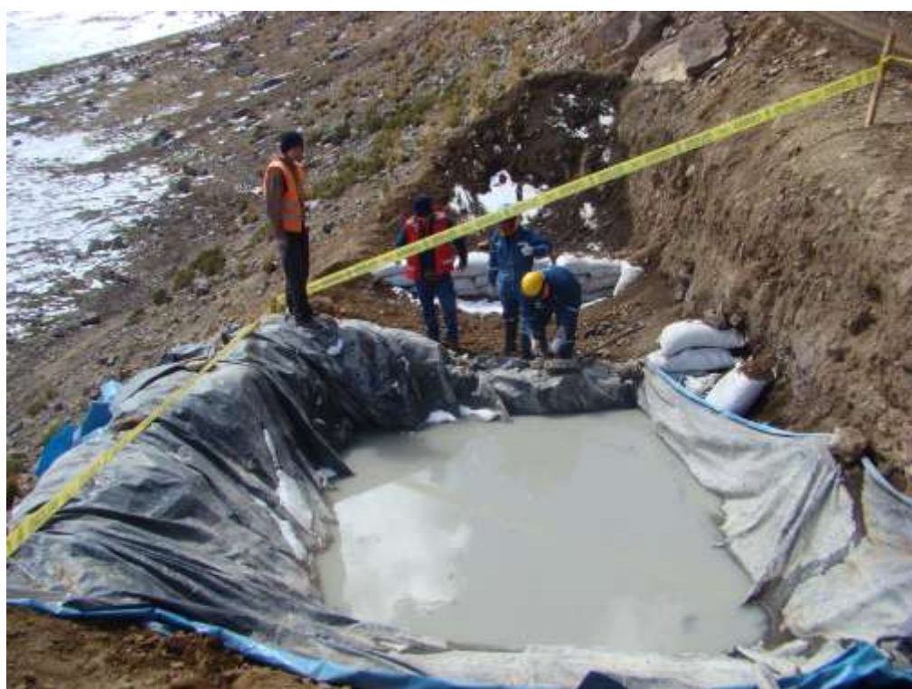
Foto 17. Toma de muestras de lodos en la poza de lodos (Chi_3) utilizado en la perforación.
