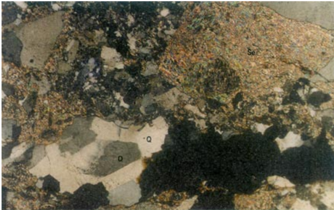
Foto N° 5.3 Microfoto de hidrotermalita silícea. Componentes: cuarzo (Q), sericita (Se) e illita (It).
