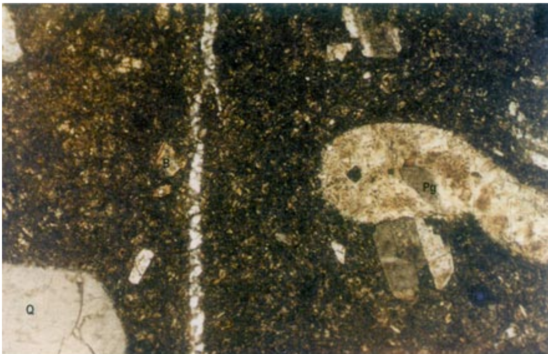
Foto N° 5.4 Microfoto de cuarzo latita porfírica. Componentes: cuarzo (Q), plagioclasa (Pg) y biotita (B).
